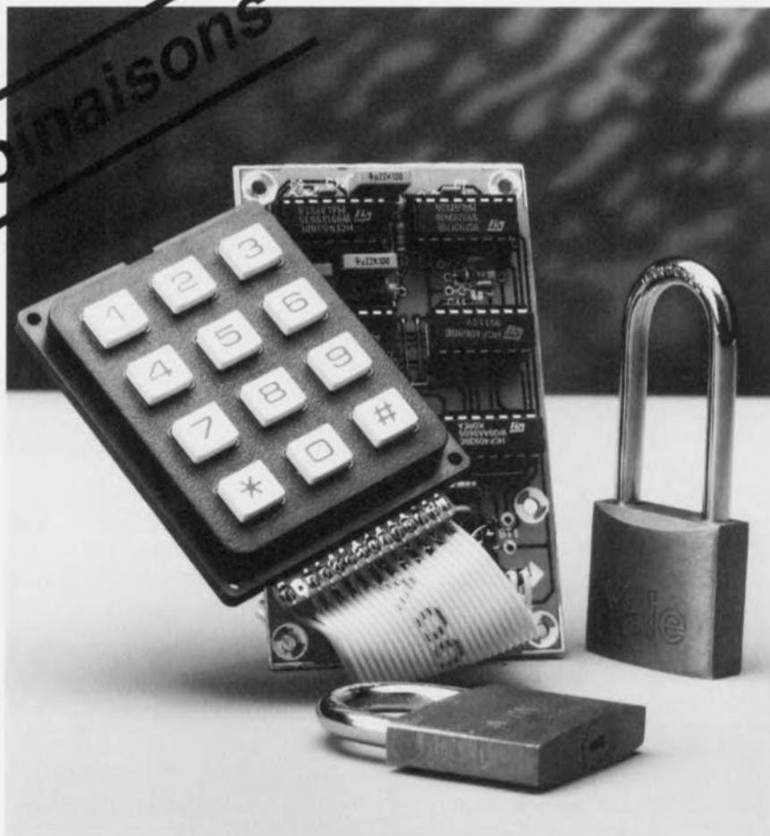
Cette serrure codée électronique, facile à construire, offre l'avantage de se passer de tout composant insolite ou en voie de disparition. Le code a une longueur de six chiffres, choisis librement, à introduire au clavier. Le déverrouillage n'est obtenu que si le code complet est exact.
