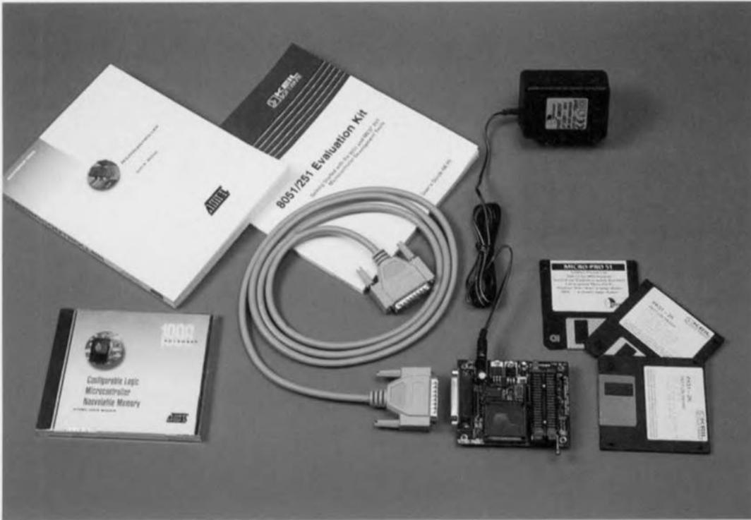
Equinox Technologies Starter System. Cet ensemble contient le programmeur Micro-Pro complet avec son alimentation, le câble parallèle, un échantillon de micro-contrôleur AT89C2051, l'ensemble PK51-2K IDE + manuels, CD-ROM et fiches techniques.
