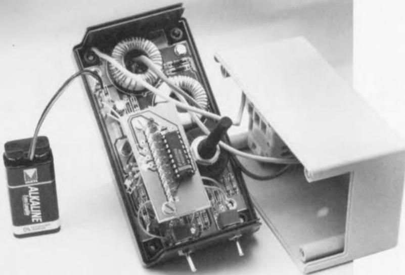
**Figure 3. Photo d'un prototype terminé. On voit nettement que la ligne de terre suit un autre trajet que les lignes de phase et de neutre.**
