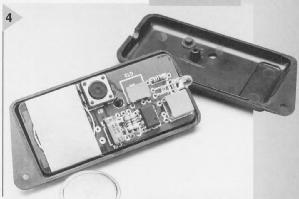
Figure 4. La platine de l'émetteur est dessinée sur mesure pour trouver place dans un boîtier de porte-clef. Le contact entre la platine et le pôle négatif de l'alimentation est réalisé à l'aide d'un morceau de tôle de laiton soudé par le dessous à ses 4 coins.
