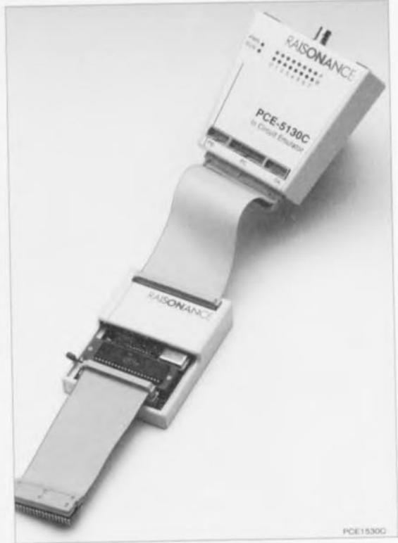
Figure 1. Exemple-type d'un outil de développement pour microcontrôleur. Il s'agit en l'occurrence d'un émulateur en temps réel. (Document Raisonance)
