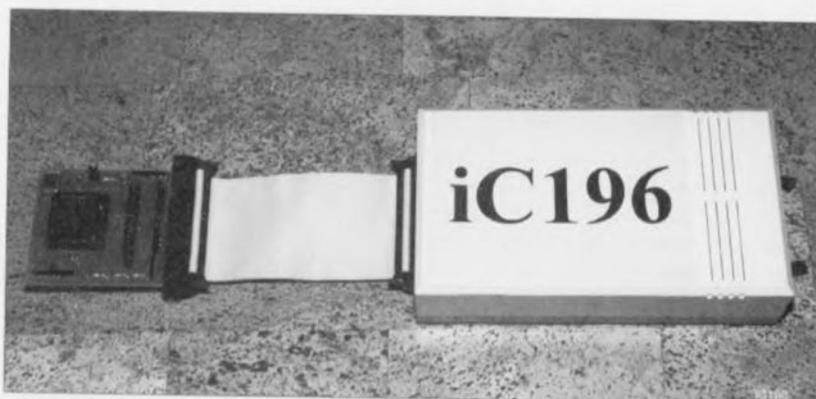
Figure 7. Voici l'un des produits les plus modernes destinés aux membres de la famille du 80C196, l'iC196, un émulateur en temps réel en circuit. (Document iSYSTEM)
