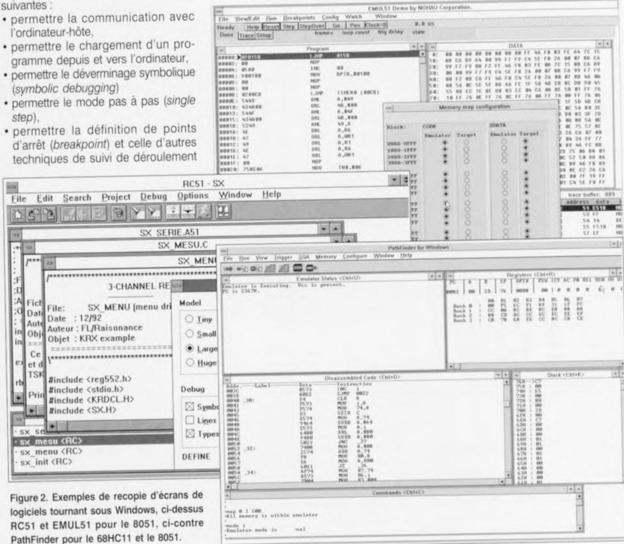
Figure 2. Exemples de recopie d'écrans de logiciels tournant sous Windows, ci-dessus RC51 et EMUL51 pour le 8051, ci-contre Pathfinder pour le 68HC11 et le 8051.
