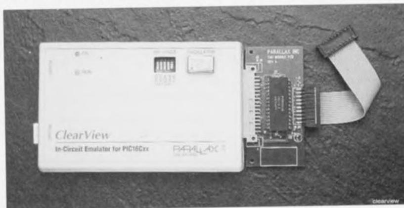
Figure 9. Un joli produit de chez PARALLAX. Le ClearView, un émulateur ice pour PIC16Cxx, tournant à quelque 20 MHz, l'émulateur, pas les PIC... (Document PARALLAX)
