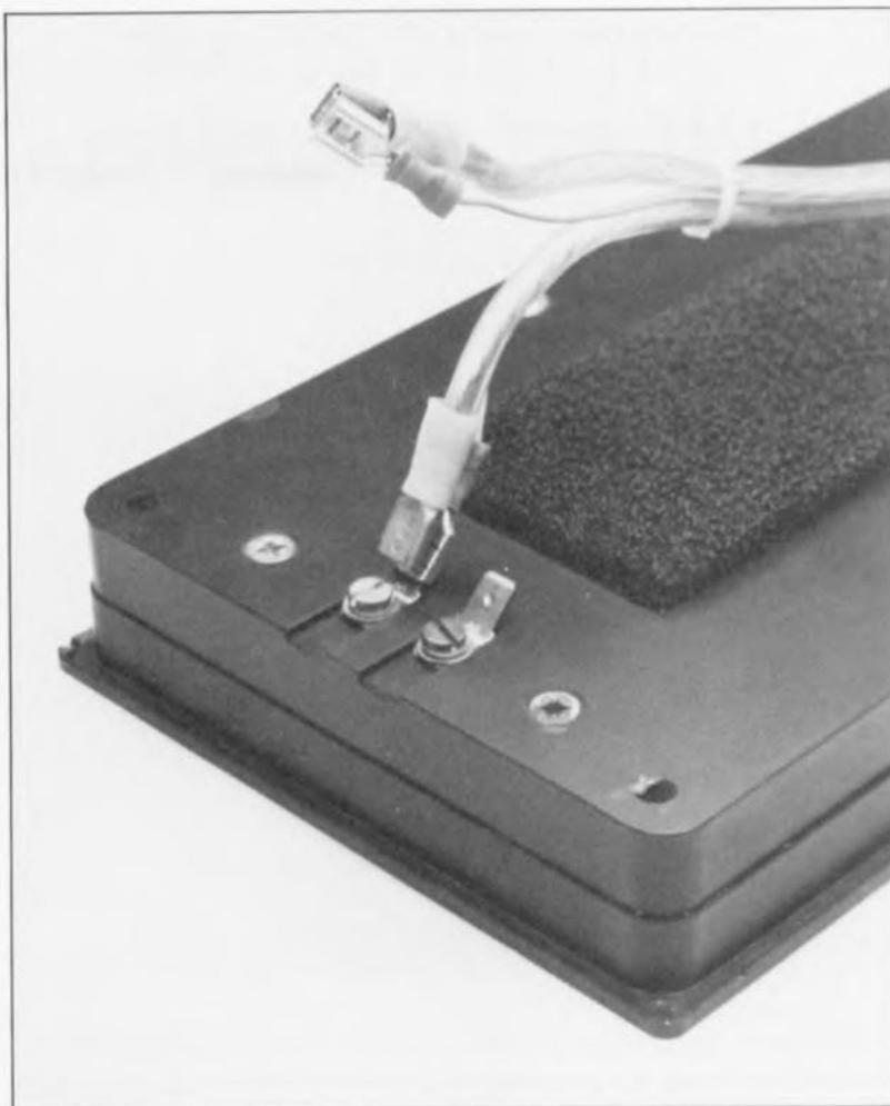
**Figure 12.** Voici à quoi ressemble le câble de connexion reliant l'amplificateur au haut-parleur; on voit comment « intégrer » les lignes de détection (une dans chaque creux) dans le câble.
