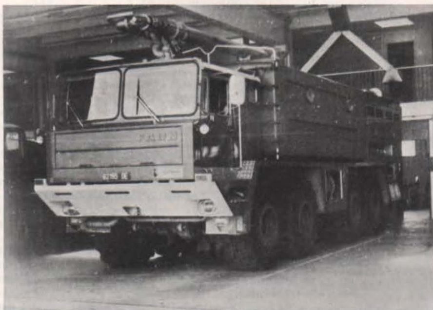
PHOTO D : Le « Monstre », utilisé par les pompiers, au garage dans le bâtiment d'intervention secours. Remarquons que le camion est toujours garé à la même place, rigoureusement, de façon à ce que les gaz d'échappement soient aspirés par la double cheminée en V inversé que l'on distingue à l'arrière du véhicule.
