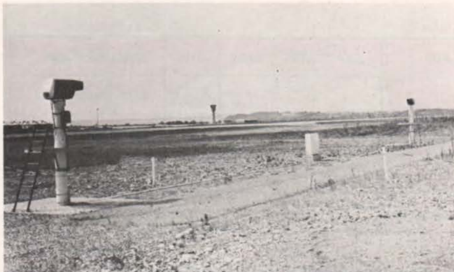
PHOTO C : Il s'agit de deux « canons » pointés l'un sur l'autre et munis de cellules photoélectriques. Ces deux canons sont disposés à une trentaine de mètres l'un de l'autre. Ils servent à mesurer la densité de brume ou de brouillard qui existe éventuellement
