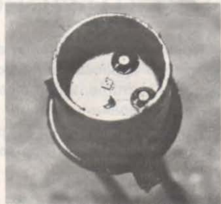
Un transistor planar (ici un BC 109) dont on a ouvert le boîtier constitue un excellent photo-transistor non directif.
