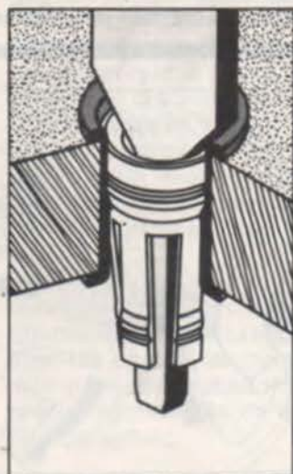
Système d'enfichage de composant utilisant le contact Holtite TM.
