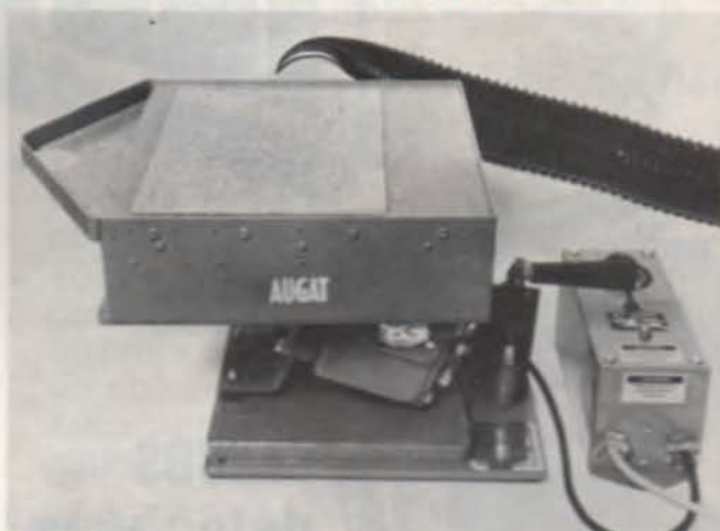
La machine équipée d'un pot vibrant permettant l'implantation des contacts sur circuit imprimé jusqu'à 60 000 unités dans l'heure.
