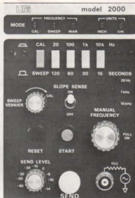
Les commandes, section générateur. En haut, les voyants à diode LED, sélection de vitesse, de calibration, vernier de vitesse et mise en service du détecteur de pente, boutons de départ, commande de fréquence manuelle, niveau de sortie, vis de blocage du tiroir.
