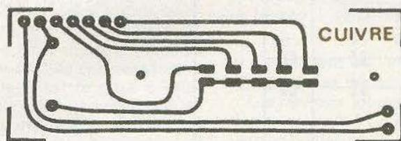
Fig. 5 et 6. - Nous vous livrons, comme d'usage le tracé du circuit imprimé à l'échelle 1 pour un meilleur transfert, à l'aide d'éléments de gravure directe, ou bien au moyen du procédé photographique et de l'époxy présensibilisé. Plan de câblage général du montage.
