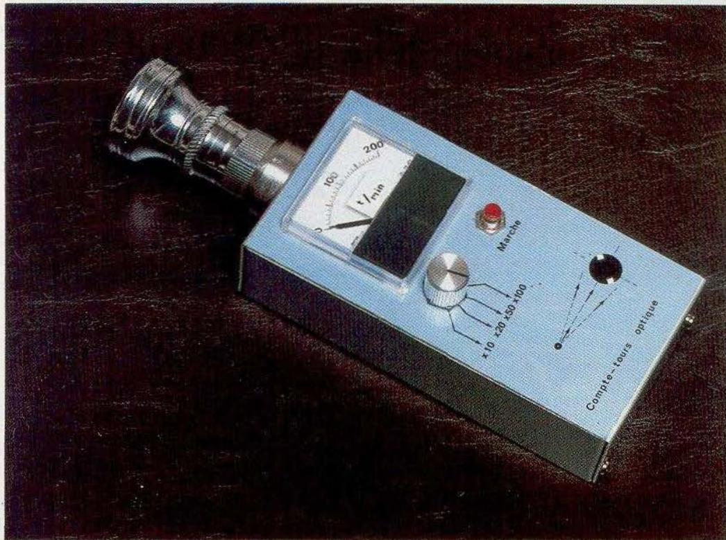
la vitesse de rotation, ce qui représente un avantage considérable sur la mesure par compte-tours mécanique qui risque d'affecter la vitesse d'un moteur de faible puissance tel que celui animant un modèle réduit par exemple.
