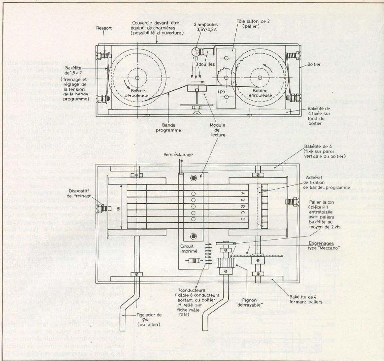
**Fig.9 - Exemple pratique de réalisation de la partie mécanique à l'aide de pièces et d'engrenages type « Meccano ». Pour plus de facilité, le montage été introduit à l'intérieur d'un coffret P/3 facile à travailler.**
