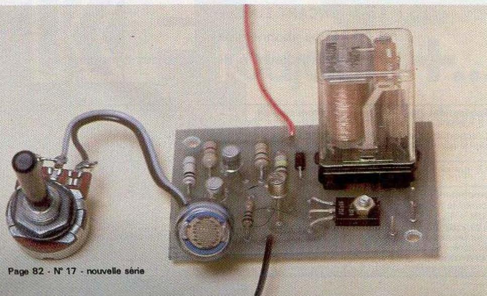
Ce dernier pourra être maintenu à l'aide d'une vis et d'un écrou, à condition de préparer les perçages du circuit imprimé.
