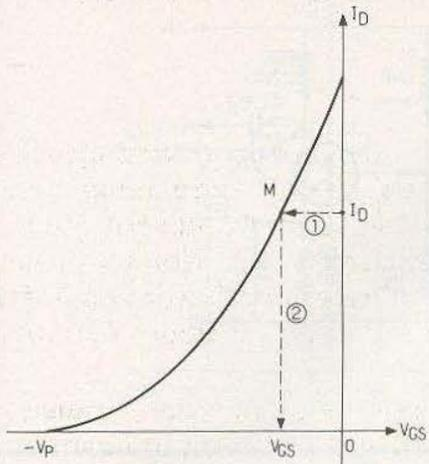
On dit encore qu'on détermine le **point de fonctionnement**, ce que nous précisons à l'aide de la **figure 4**.
