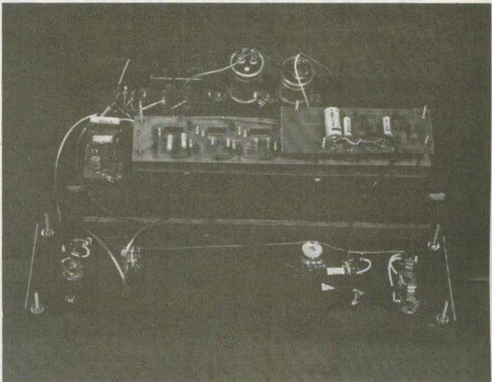
Photo 1. – Le montage a été introduit à l'intérieur d'un coffret genre rack 19 pouces. On remarquera les deux circuits imprimés constituant les douze filtres.
