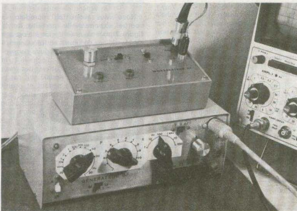
Photo 3. – De gauche à droite de la face avant, nous trouvons : P 3 , K 1 , K 2 , l'entrée de synchro et en bas deux points de contrôle de tensions.
