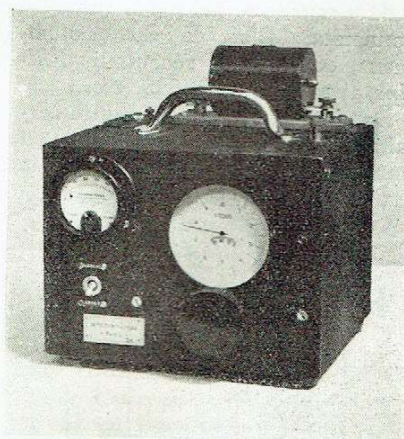
Le fréquencemètre D. 1559 de la Précision Electrique.
