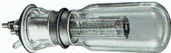
*Version expérimentale d'un tube E1567 dans laquelle l'anode a été remplacée par une ampoule de verre afin de permettre l'observation du filament au cours de 5 000 brusques mises sous tension consécutives. Une version antérieure d'un tube E1300 illustre la couverture de ce numéro.*
