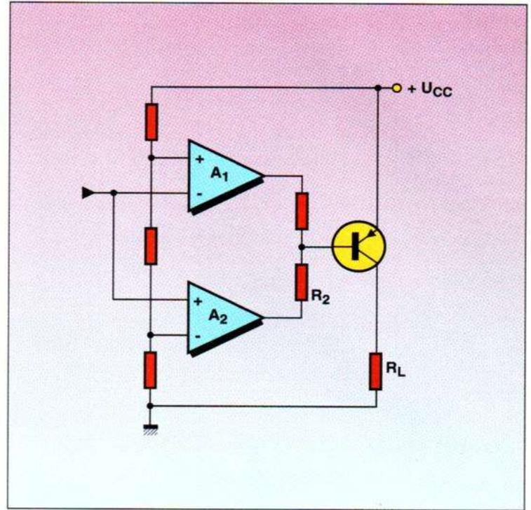
Fig. 9. – Version de la figure 7 dans laquelle un transistor de sortie PNP commande une charge retournant à la masse.
