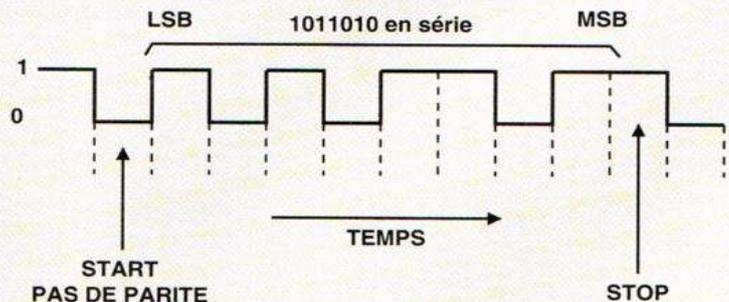
Figure 1. Exemple de transformation d'un octet avant d'être transmis sur un seul fil.
