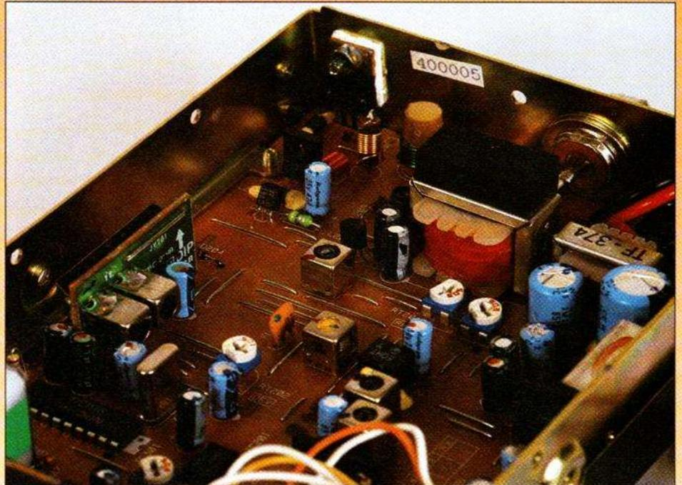
On ne voit pas trop de résistances ici, elles sont placées sous le circuit imprimé. Le transformateur est utilisé pour la modulation d'amplitude, il ajoute ou retranche sa tension à celle d'alimentation.
