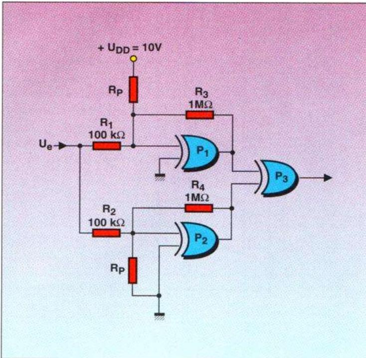
Fig. 12. – Associant trois OU exclusifs, ce discriminateur à fenêtre permet une commutation avec hystérésis.
