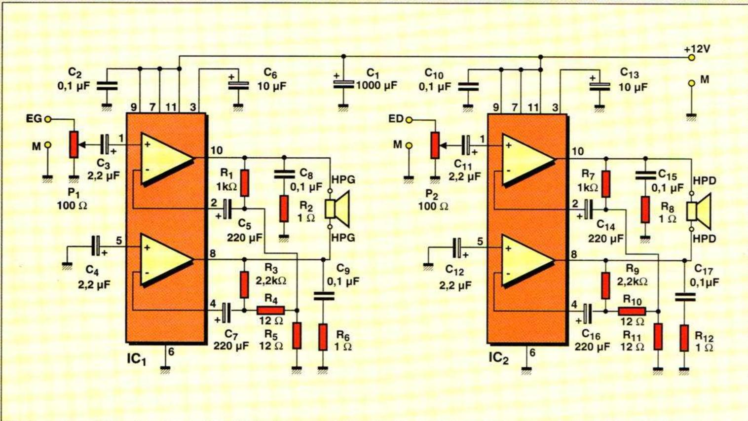
Figure 1 : Schéma de notre montage
