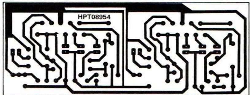
Figure 2 : Circuit imprimé, vu côté cuivre, échelle 1
