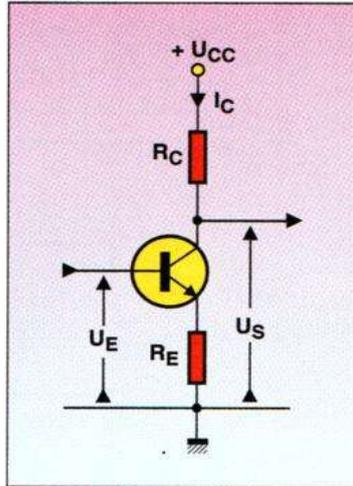
Fig. 5. – Jusqu'à sa saturation, le transistor travaille avec inversion de phase. Ensuite, la tension de collecteur suit celle de base.
