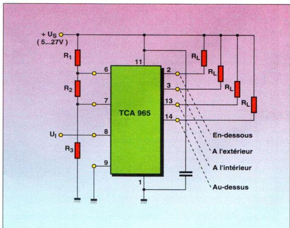
Fig. 1. – Dans ce schéma d'utilisation du TCA 965, un diviseur à trois résistances définit les bords de la fenêtre.
