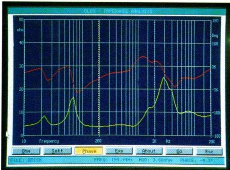
C Comme l'indique l'écran, le Brick présente un minimum d'impédance à 3,6 W, vers 200 Hz. Au dessus de 900 Hz, c'est le transducteur coaxial qui impose sa charge, au profil accidenté mais assez régulier en phase.
