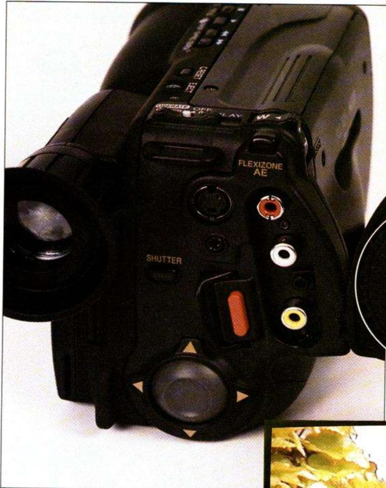
C'est à l'arrière que se trouvent les prises de sortie du caméscope. Dans le bas, une grosse touche déplacera le curseur dans les deux directions. La touche placée près de la commande de zoom permet d'assurer un réglage de luminosité par l'intermédiaire de la zone «flexible»
