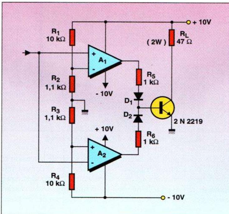
Fig. 7. – Un double comparateur, suivi d'un OU à diodes, permet de commander des puissances de commutation relativement importantes.
