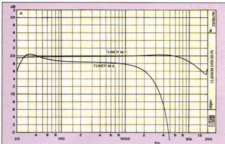
Courbe A - Courbes de réponse en fréquence du tuner de l'autoradio Clarion. La réponse dans le grave du tuner de M.A. est particulièrement large.
