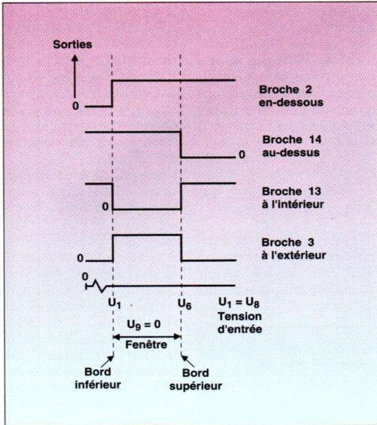
Fig. 2. – Diagramme illustrant le fonctionnement du montage de la figure 1.
