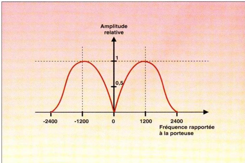
Figure 2 - Spectre des signaux de données modulées.
