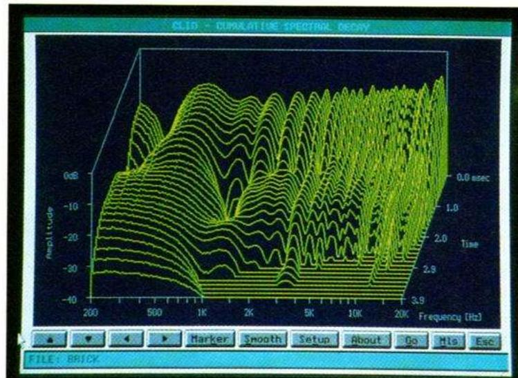
D Le diagramme 3D d'amortissement, dont la fenêtre temporelle (4 ms) a été choisie en fonction de la réponse impulsionnelle, montre, au dessus de 1 000 Hz, une décroissance spectrale rapide et homogène, à porter au crédit du transducteur médium aigu BC12.
