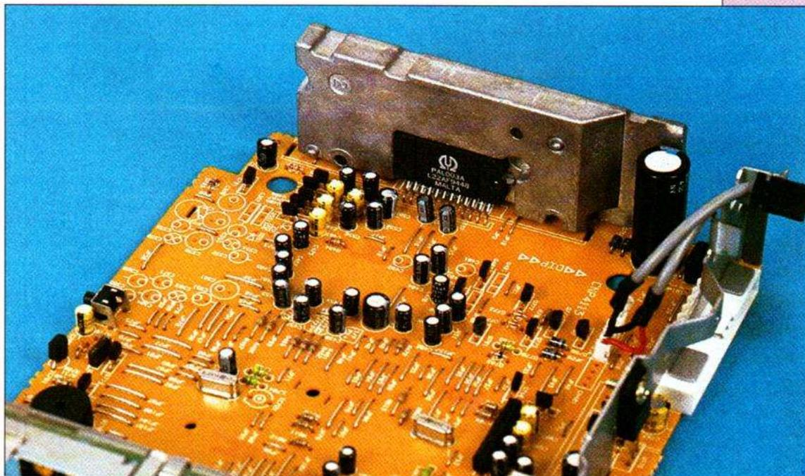
L'amplificateur de puissance est refroidi par ce bloc de zamack. Devant, les condensateurs chimiques entourent un circuit intégré placé de l'autre côté du circuit de stratifié phénolique. L'ensemble est assez désertique, quelques cavaliers de cuivre assurent des liaisons entre les 2 faces.
