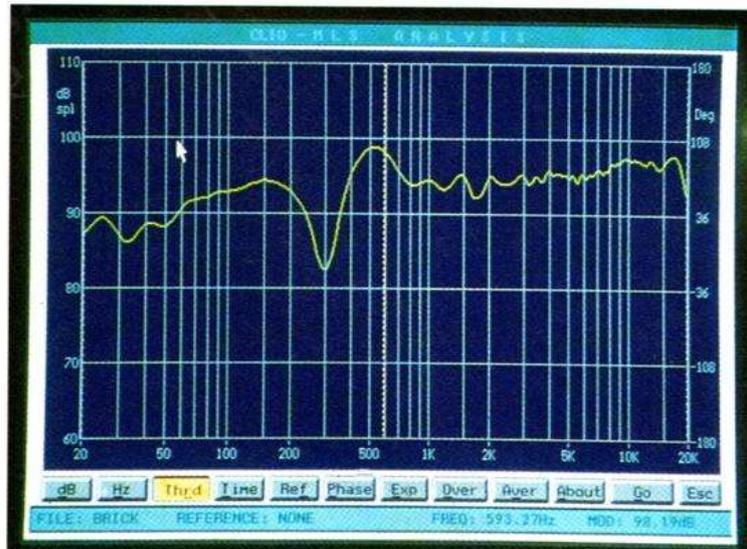
B Comme souvent avec les systèmes dits d'Appolitto, l'emplacement du microphone de mesure fait apparaître un creux dans la courbe de réponse (ici à 400 Hz). Globalement le Brick offre une réponse ascendante en pente douce qui s'équilibrera naturellement dans le local d'écoute. La directivité verticale est peu sensible sur ce modèle ; dans le plan horizontal, le Brick fournit un jeu de courbes descendantes sans accident notable.
