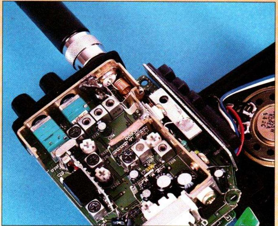
Plongée dans les entrailles du Pro 101. On voit ici les modules implantés perpendiculairement au circuit principal. On a ajouté quelques blindages. Le tout sera protégé par un couvercle d'aluminium épais, vissé sur la ceinture de laiton et qui aidera à dissiper la chaleur des transistors et du circuit intégré.
