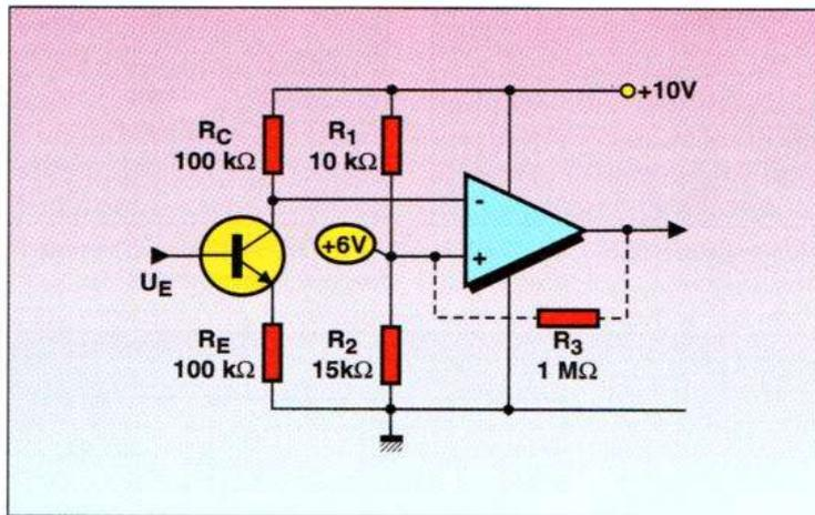
Fig. 6. – Emploi d'un transistor transparent dans un discriminateur à fenêtre simple et néanmoins utilisable avec hystérésis.
