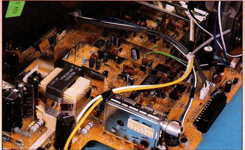
Vue intérieure du 1440 TF, On aperçoit ici le composant central, un circuit qui rassemble pratiquement toutes les fonctions d'un téléviseur couleur. Sur le devant et à gauche se trouve l'alimentation à découpage.
