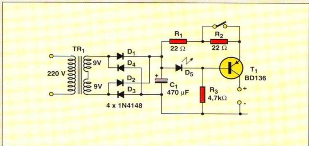
Figure 1 : Schéma de notre montage
