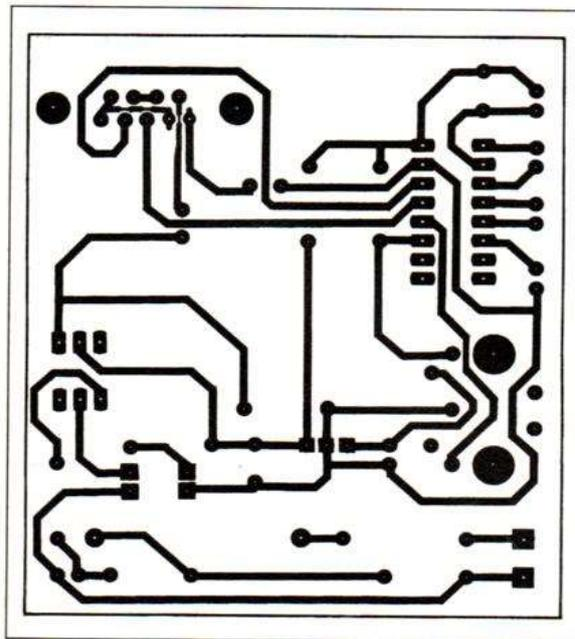
Figure 2 - Circuit imprimé, échelle 1, de l'interface PC/Minitel
