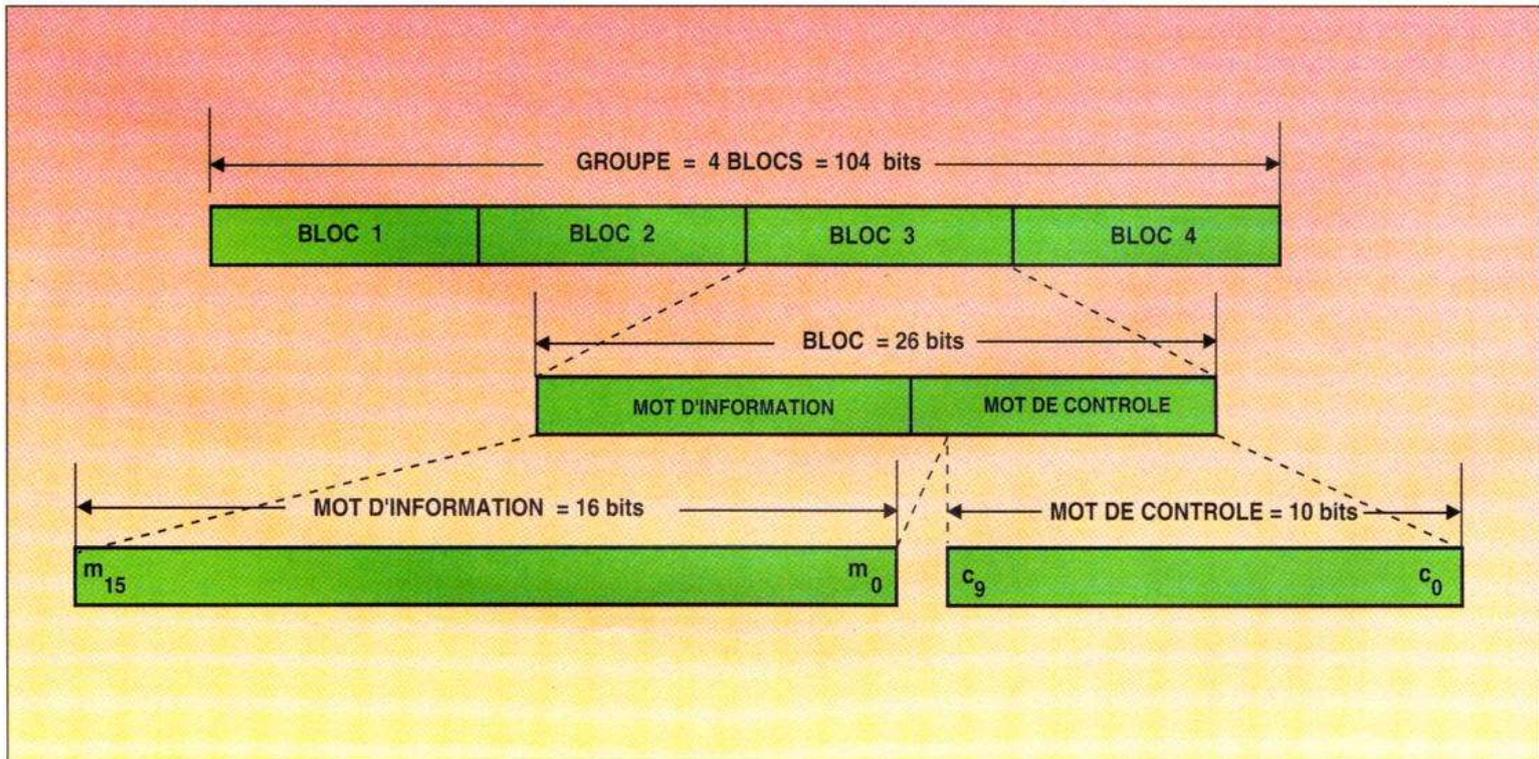
Figure 3 - Codage en bande de base.
