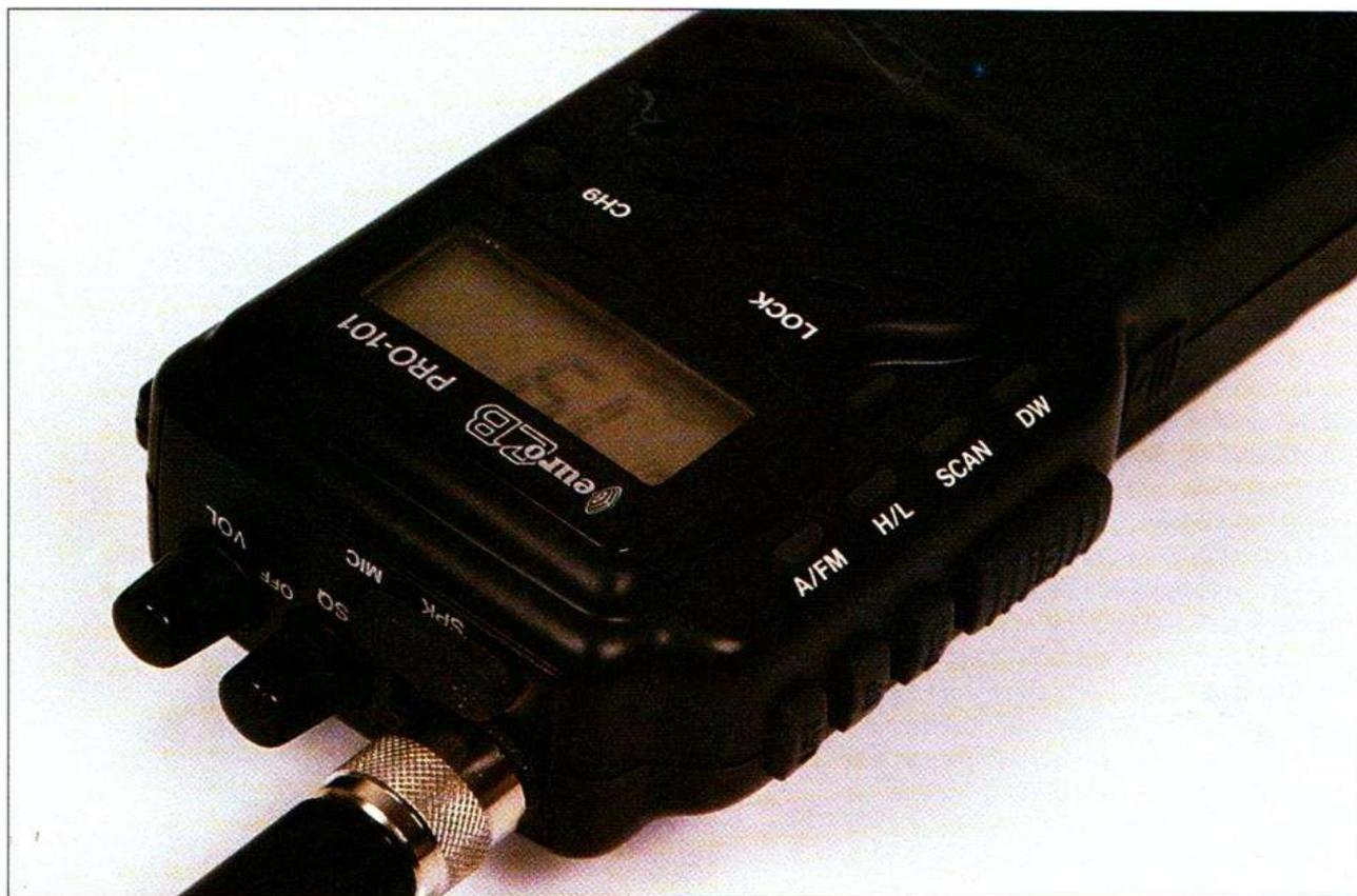
La puissance change avec la tension d'alimentation, ce qui est assez normal s'il n'y a pas de régulateur dans l'appareil. La puissance moyenne est identique que l'on soit en modulation d'amplitude ou de fréquence, ce qui nous donnera une puissance de crête supérieure aux 4 W imposés.
