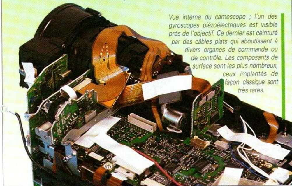
*Vue interne du camescope ; l'un des gyroscopes piézoélectriques est visible près de l'objectif. Ce dernier est ceinturé par des câbles plats qui aboutissent à divers organes de commande ou de contrôle. Les composants de surface sont les plus nombreux, ceux implantés de façon classique sont très rares.*
