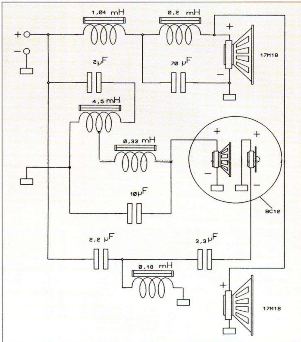
Le filtre : malgré l'utilisation de nouveaux haut-parleurs, le filtre affiche un classicisme éprouvé : toutes les sections sont à 18 dB par octave, garantissant une faible intermodulation et une puissance admissible élevée.
