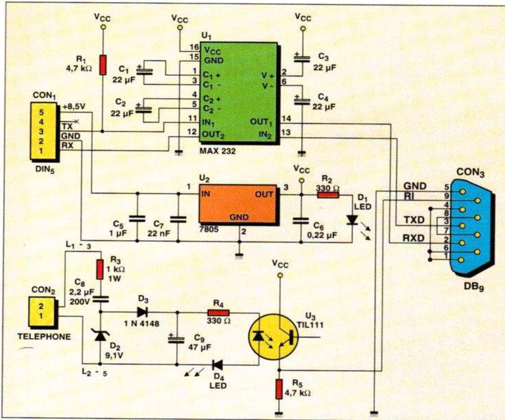
Figure 1 - Schéma de l'interface PC/Minitel
