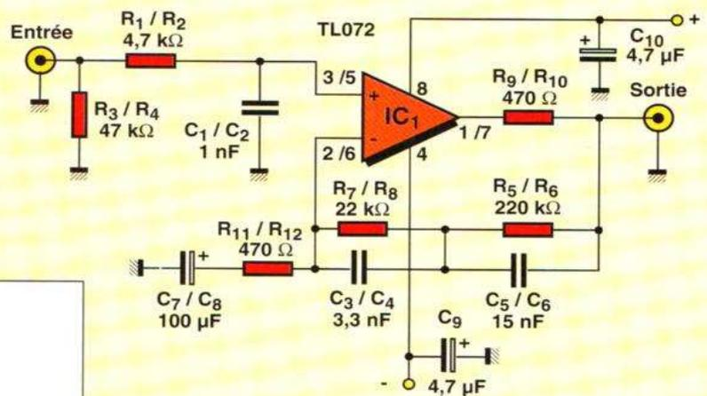
Figure 1 : Schéma de notre montage
