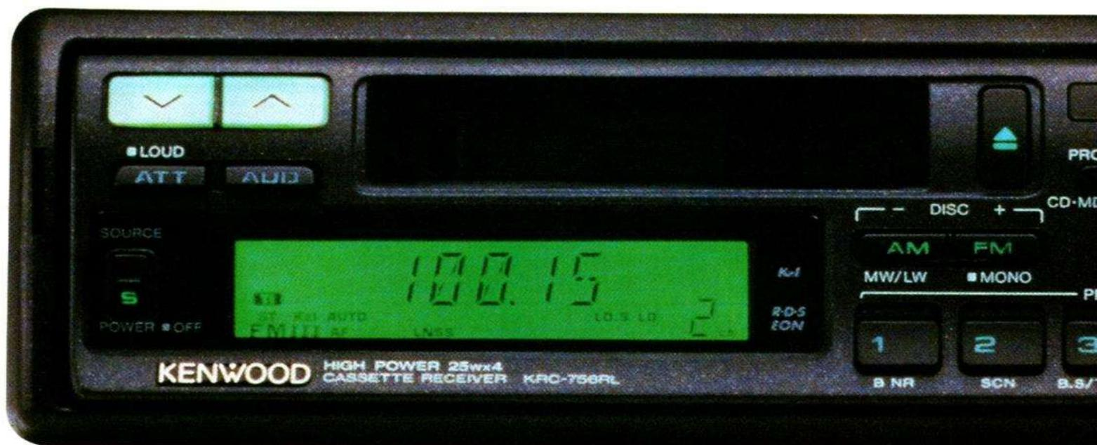
Le KRC-756RL est un autoradio-cassette RDS capable aussi de commander un changeur de CD. Point intéressant, la firme japonaise propose une télécommande qui s'installe sur le volant et communique par infrarouge avec l'autoradio.
