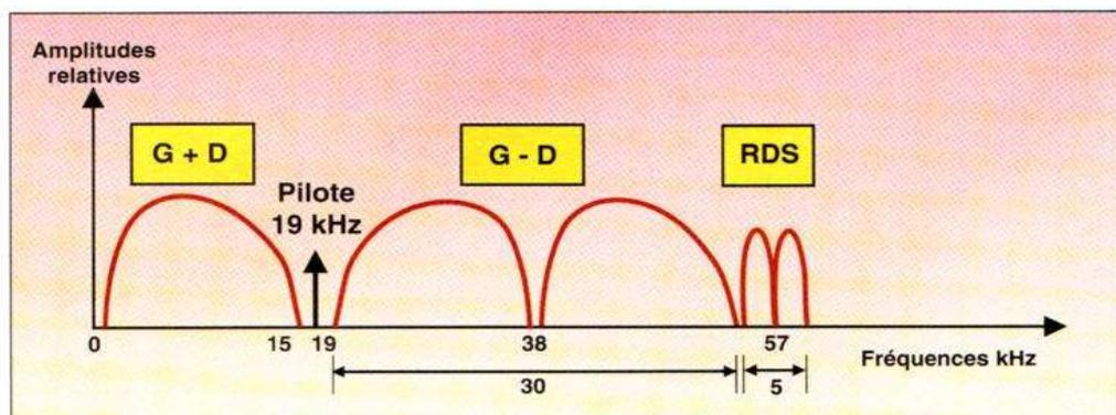
Figure 1 - Spectre du signal multiplex en modulation de fréquence, émission stéréo avec RDS, comme on peut le trouver à la sortie du discriminateur de tout récepteur F.M.
