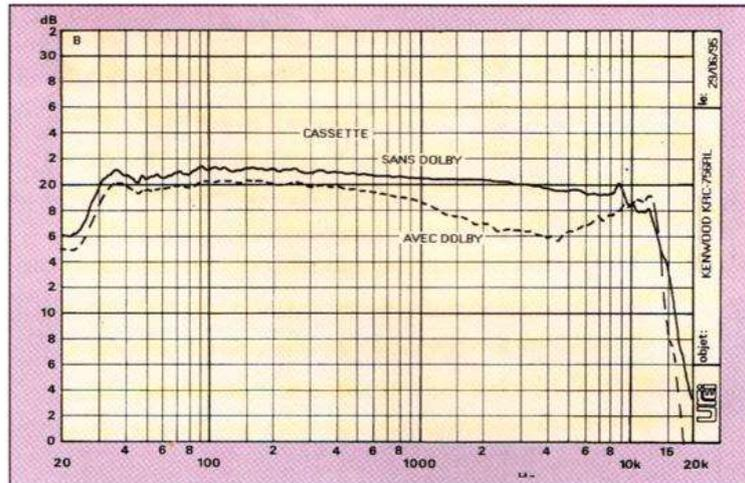
Courbe B - Courbes de réponse en fréquence du lecteur de cassette, si la réponse est correcte sans réducteur de bruit, l'intervention de ce dernier se traduit par un creusement caractéristique du haut médium, il est dû à une erreur d'alignement du niveau.
