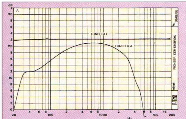
Courbe A - Courbes de réponse en fréquence de la section radio de l'autoradio Pioneer. Réponse très rectiligne pour le tuner M.F. et standard pour la M.A. avec une atténuation du grave, donc, un certain équilibre du spectre.
