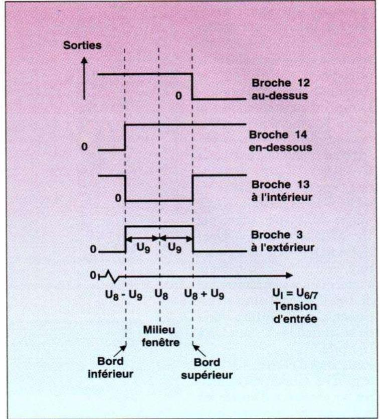
Fig. 3. – Schéma d'utilisation permettant de choisir, de façon indépendante, la largeur de la fenêtre et son emplacement.
