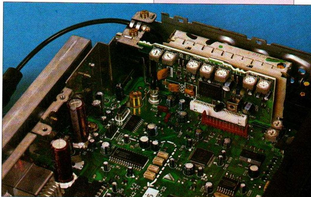
La platine placée contre le tuner est un circuit de réduction de largeur de bande FI en cas d'interférences. Les amplis de puissance sont sur la gauche, vissés au bloc de zamack. L'espace libre est rempli par la platine à cassette.
