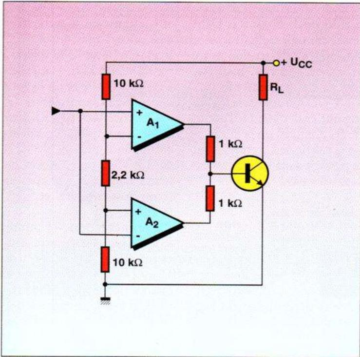
Fig. 8. – Version à alimentation unique du montage de la figure 7. L'émetteur du transistor de sortie retourne sur le négatif de l'alimentation.
