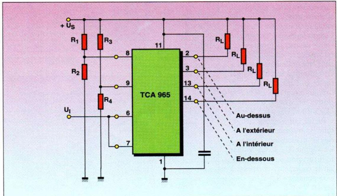
Fig. 4. – Diagramme de fonctionnement relatif au montage de la figure 2.
