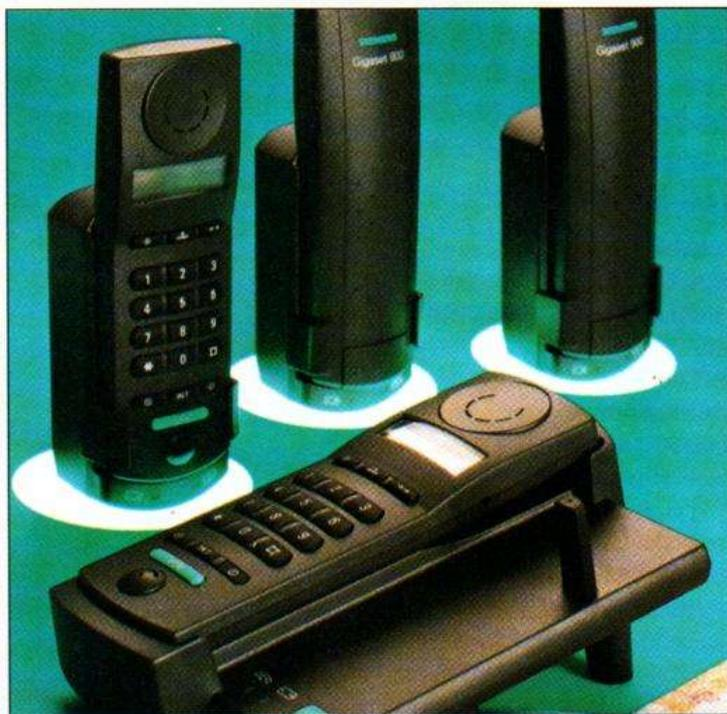
geur secteur indépendant. La sonnerie, qui dispose de six niveaux sonores et de six mélodies, retentit à la fois sur la base et sur le combiné. Le volume de conversation est réglable sur trois niveaux. La numérotation peut être décimale ou à fréquence vocale. La portée en extérieur avoisine 300 à 400 mètres. Utilisant des fréquences supérieures à 1 800 MHz, le Gigaset 910 offre une très bonne pénétration en bâtiment.
