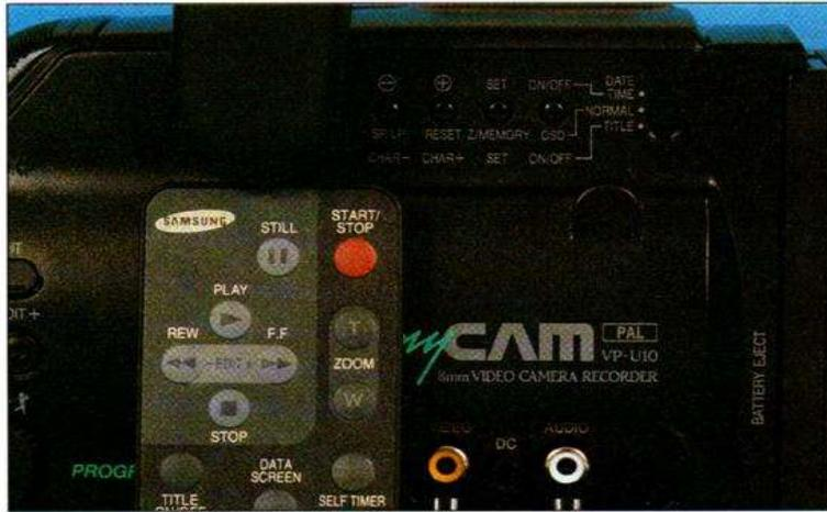
Un mini-clavier s'abrite derrière le viseur. La télécommande facilite les commandes en lecture et au montage.
