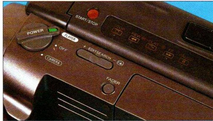
Une idée originale : un clavier lumineux qui ne s'allume qu'en lecture. Sur sa gauche, le second bouton de départ d'enregistrement, il y a également une double commande de zoom.
