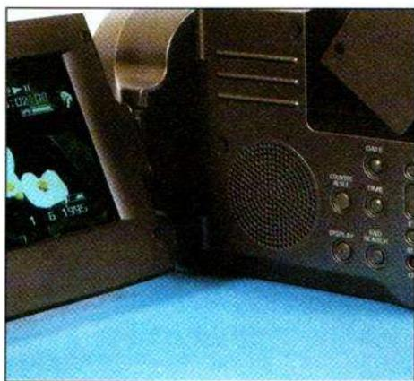
La grille protège un haut-parleur de contrôle ; quatre touches sont affectées au menu, le stabilisateur d'image bénéficie d'un commutateur mécanique, d'autres commandes, plus usitées sont prévues à l'arrière.
