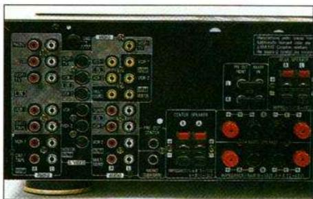
La face arrière reçoit les prises de raccordement. Denon les a réparties en plusieurs zones fonctionnelles. Notez également les différents standards vidéo...
