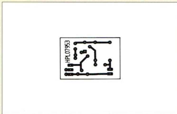
Fig. 2. - Circuit imprimé, vu côté cuivre, échelle 1.
