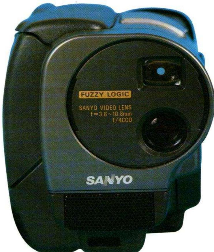
Le viseur est bien optique, l'électronique est assistée par une logique floue, c'est écrit dessus...
