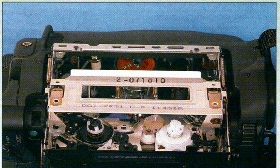
La platine mécanique ultra légère : au fond, le petit tambour vidéo coiffé de son moteur. Canon associe ici, comme ses confrères, matières plastiques et métaux divers.
