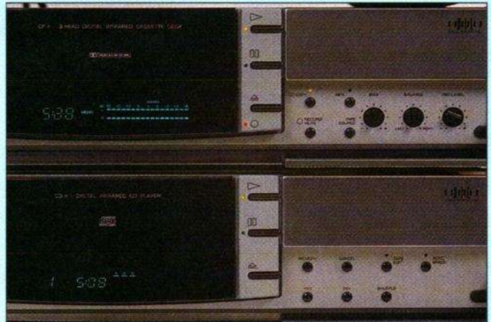
Des commandes secondaires sont cachées derrière des volets. chaque appareil a un afficheur correspondant à sa fonction, plages pour le lecteur de CD, niveau pour le magnétophone.
