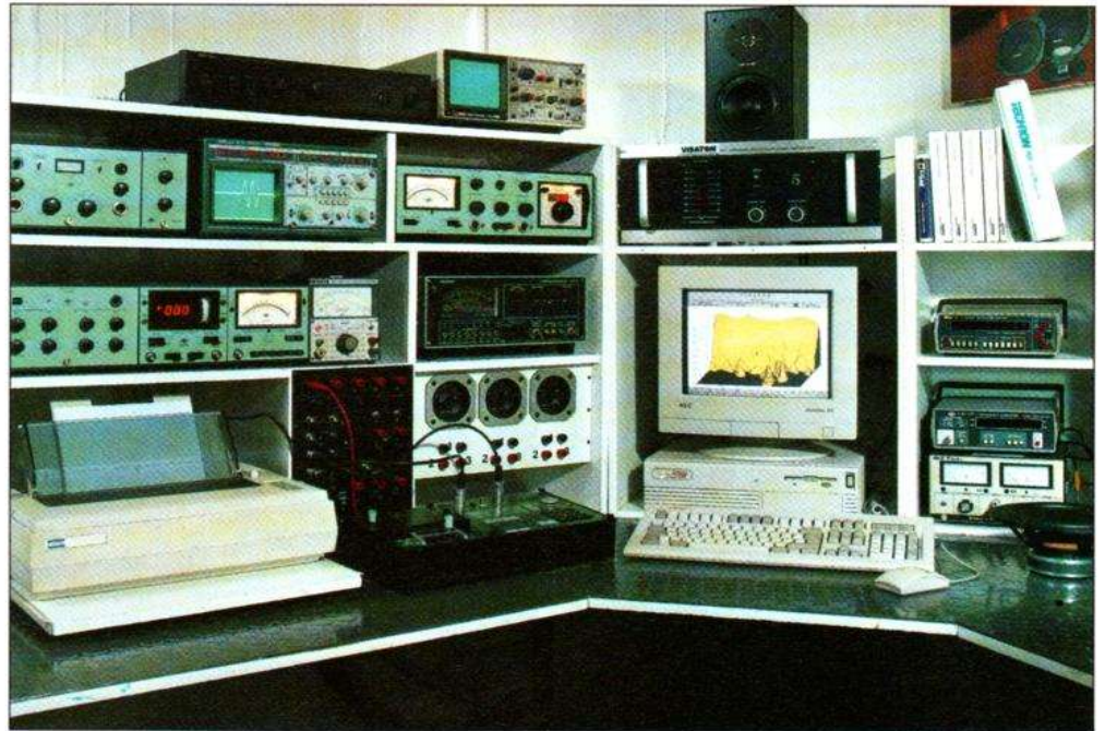
Le labo de contrôle, situé juste à côté de la chambre sourde. Diverses générations de matériel s'y côtoient : un banc classique Brüel et Kjaer (couleur vert de gris caractéristique), une table traçante Neutrik, mais surtout un Compaq 486 équipé d'un gros logiciel de mesure, dont celle de décroissance spectrale, que l'on distingue en jaune, à l'écran. Auparavant, Visaton utilisait aussi le système TEF Techron (comme nous-même, au HP) ; on en distingue d'ailleurs encore le mode d'emploi, en haut, à droite.
