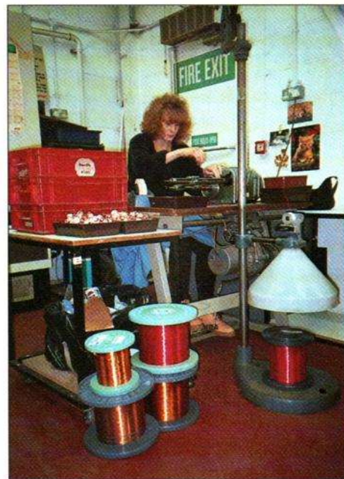
Les bobines des filtres sont faites sur place, sur des noyaux fer de marque Wicon. La valeur des selfs est ajustée très précisément à ce stade, selon la répartition statistique de la précision des condensateurs (tous mesurés !!). Ainsi, les filtres sont précis à 0,1 dB !
