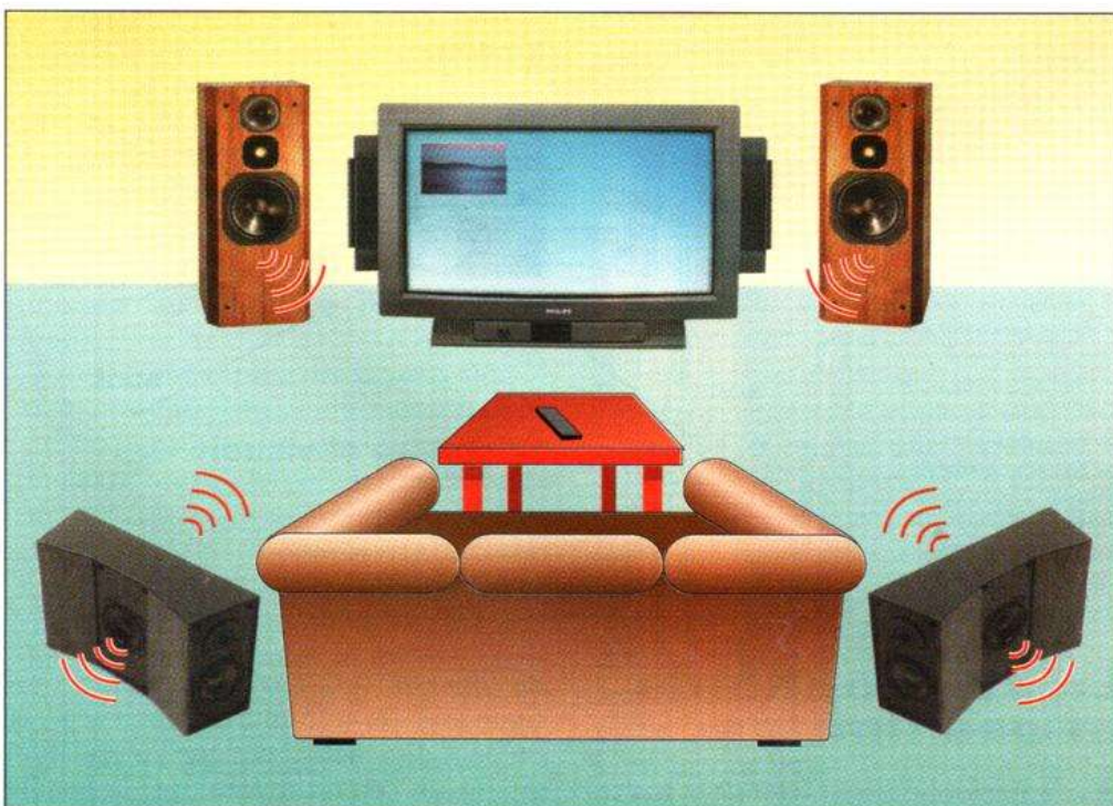
L'installation THX, utilise des enceintes d'environnement d'un type spécial rayonnant vers l'avant et l'arrière, elles se placent au niveau de l'auditeur symbolisé ici par un canapé.
