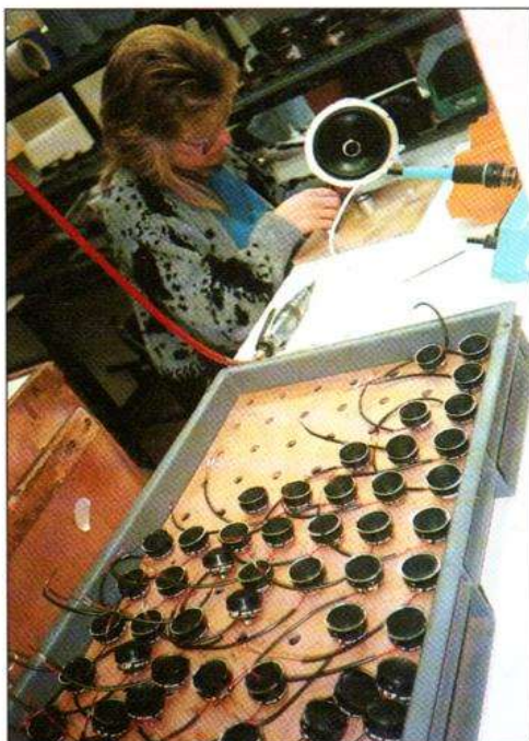
Les tweeters au neodyme (au moins un qui ne se plaindra pas) attendent la phase de montage sur la pièce polaire avant, à la place du traditionnel cache-noyau.
