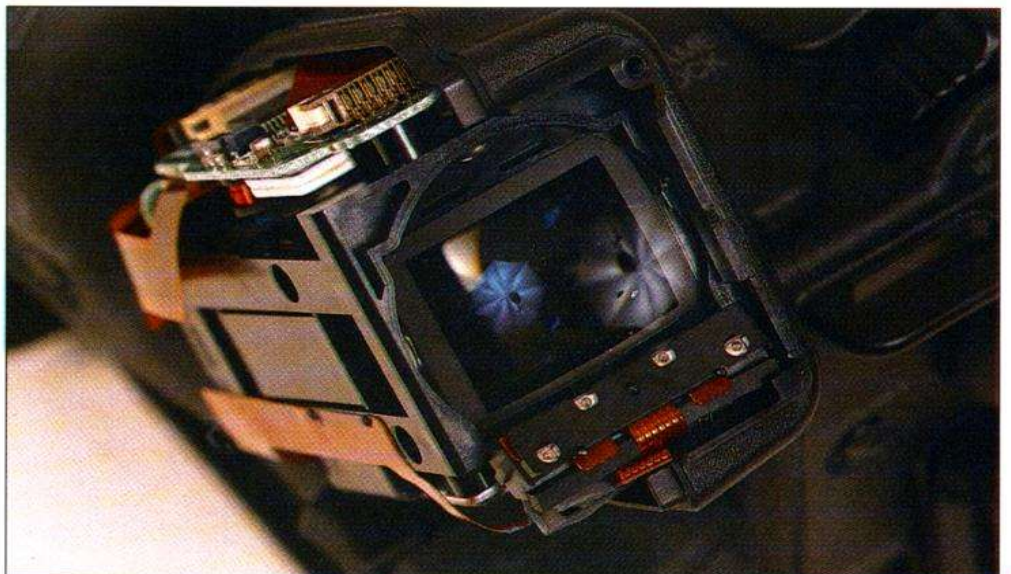
Dans le bas du viseur, quatre diodes envoient leurs signaux vers l'avant de l'œil dont on détecte la position par un capteur CCD installé à l'intérieur du viseur.
