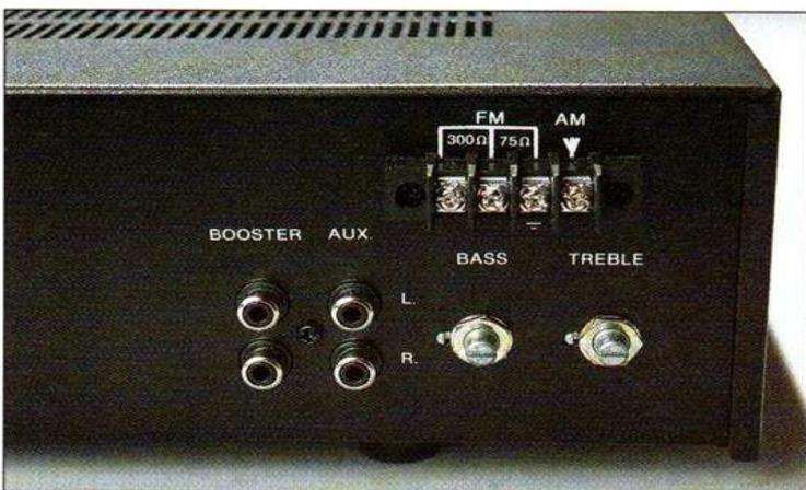
A côté des prises d'entrée on trouve des réglages de timbre avec point neutre cranté.
