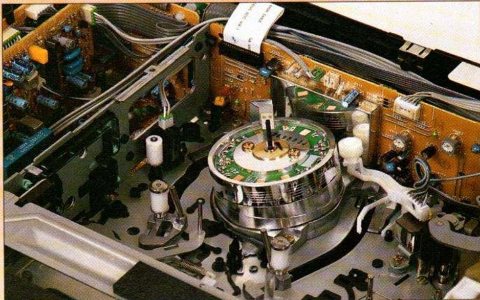
La platine mécanique utilise un châssis en épaisse tôle d'acier pliée en U. Un surmoulage de matière plastique constitue des glissières ou des points d'ancrage pour les éléments, le tambour est installé sur un bloc de zamack.
