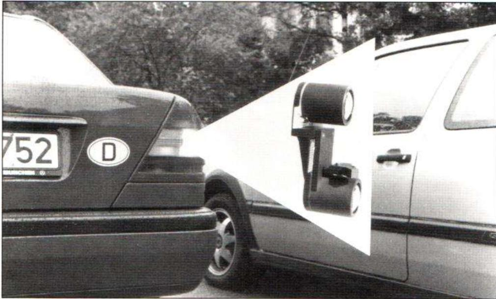
Des modules optiques placés dans les feux arrière détectent les véhicules situés dans l'angle mort à une distance de 3 m (Siemens).
