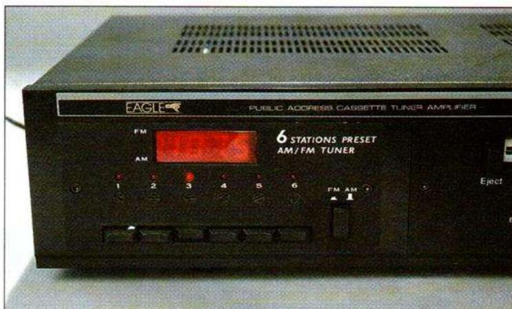
Le tuner offre des stations pré-réglables par potentiomètre. Nous aurions préféré un modèle PLL !
