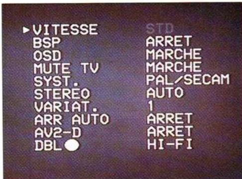
Un écran propose le paramétrage de diverses fonctions du magnétoscope.
