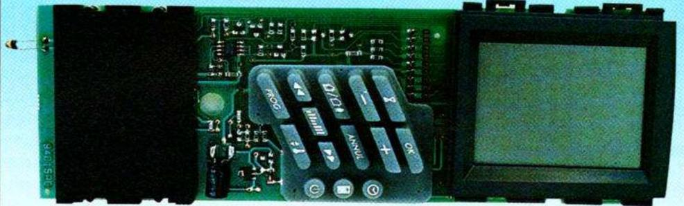
CMS et microcontrôleur (caché sous l'afficheur) constituent la belle électronique du Tybox C.
