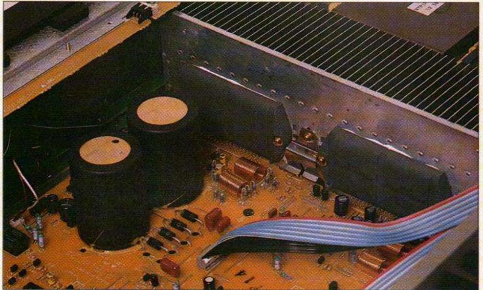
L'amplification est confiée à des modules hybrides. Les condensateurs chimiques de filtrage sont à la pulpe de bambou ! Le radiateur est à ailettes rapportées, un ventilateur, en face arrière, accélère le passage de l'air.
