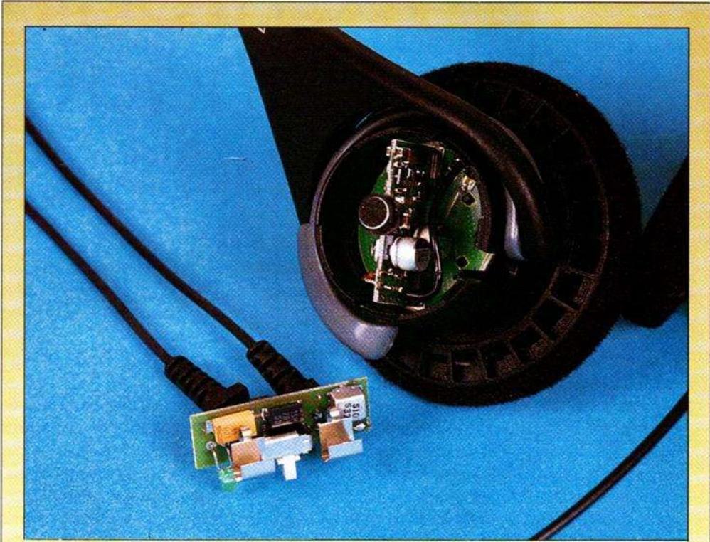
La technologie mise en œuvre par Sennheiser : une installation des composants sur les deux faces d'un petit circuit imprimé. L'autre circuit est celui du convertisseur chargé de fournir la « haute tension » à partir des deux piles de 1,5 V.
