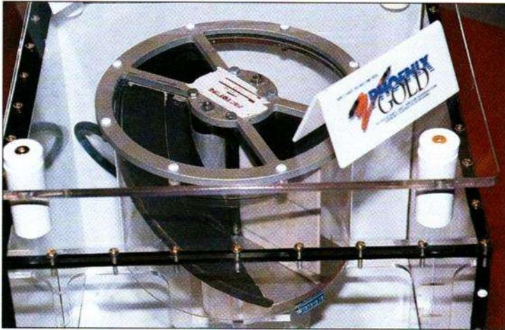
Gros plan sur le prototype de caisson de grave de Phoenix Gold, la membrane est remplacée par un volet articulé...
