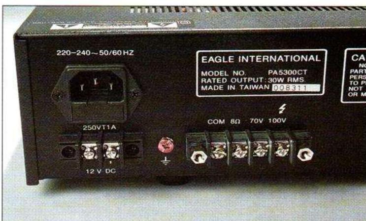
Le bornier de sortie reçoit une protection car la tension n'y est pas négligeable ! On remarque la présence d'une entrée pour alimentation 12 V continu.
