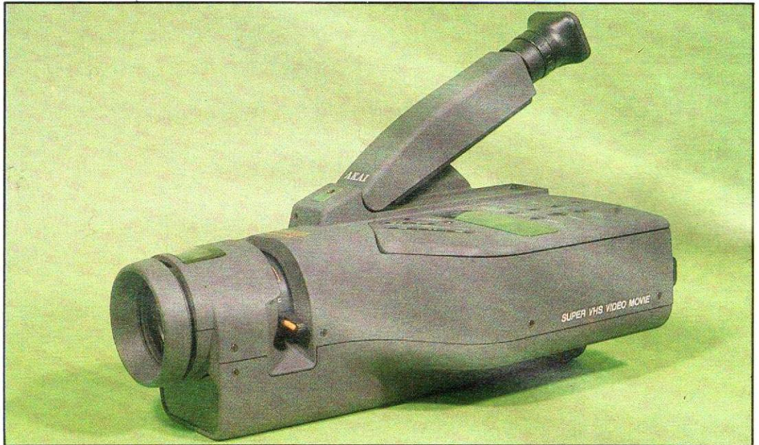
Version S-VHS du PVS-C100S. Les formes sont les mêmes. La finition n'est pas plus lisse, mais offre sous les doigts une légère granulosité qui facilite la prise en main, mais susceptible de s'encrasser assez rapidement. Ce qui frappe d'emblée c'est l'ergonomie de cet appareil : tenue à deux mains, mais exploitation optimale, pendant la prise de vue, de ce qu'il est possible de faire avec les doigts de la main gauche.
