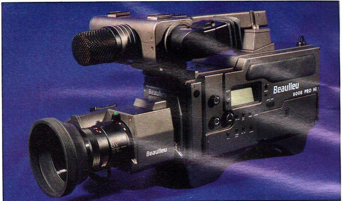
Un caméscope fabriqué en France et qui vise un marché pro. Un adaptateur pour montage C figure dans les accessoires pour ceux qui désirent changer l'objectif. Beaulieu propose cet appareil au standard Hi8 dans un coffret métallique particulièrement robuste, qui se porte à l'épaule.
