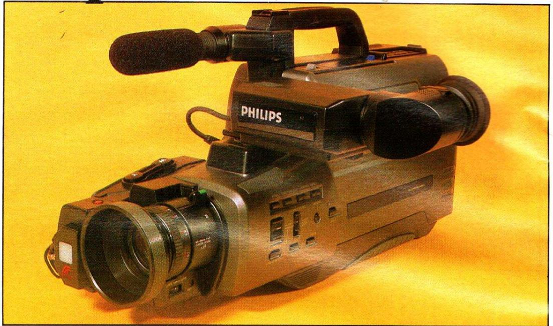
Un vrai « Vidéo Reporter ». Machine sans mystère, VHS Full Size SECAM, comme un bon magnétoscope de salon de base. Prise en main rassurante : 430 mm de long et 2,7 kg ne vous échappent pas des mains sans préavis. Le viseur coulisse latéralement : en position extrême, on peut viser avec l'œil gauche, la joue droite bien plaquée au corps de l'appareil.
