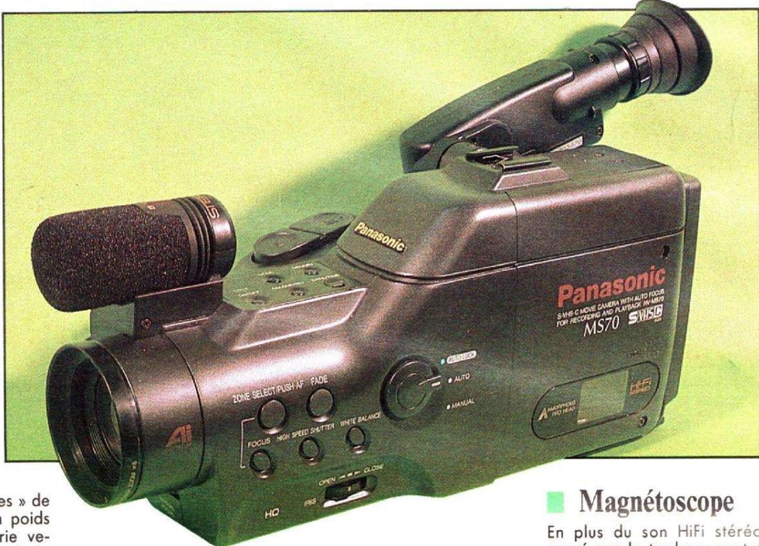
Classé parmi les « armes » de poing, le MS70 a son poids bien réparti, la batterie venant se loger au creux de la main de l'utilisateur. La partie arrière du camescope, ainsi libérée, supporte clavier et afficheur à cristaux liquides, plus naturellement accessibles et consultables sans trahir la position académique du cinéaste ; c'est-à-dire la caméra dans le prolongement du nez (c'est un pic, c'est un cap, c'est un camescope...).
