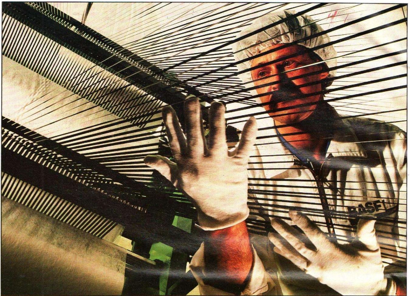
*A Willstätt, découpage des « Jumbos » – rouleaux de bande magnétique – avant le conditionnement.*
