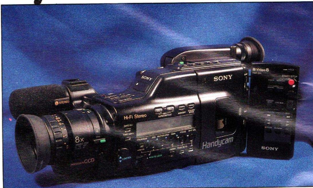
Voici sous la forme la plus réduite, disponible actuellement, « le » caméscope Hi8 Sony. Caméscope très complet, le V700E se permet de posséder quelques touches rares dans la section clavier placée au-dessus de l'appareil, et généralement affectée au fonctionnement en magnéscope (c'est d'ailleurs le cas ici...), cinq touches gérant la fonction menu, utile et utilisable tant en enregistrement qu'en reproduction, s'affichant dans le viseur ou sur l'écran du téléviseur.
