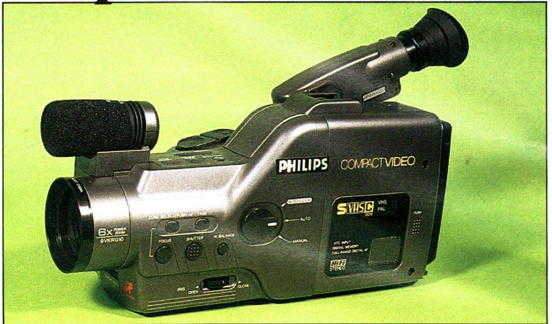
Ce caméscope de taille moyenne, à mi-chemin entre les modèles d'épaule et les mini, a une vocation presque familiale. Une utilisation simple avec un standard peu répandu dans les salons : le S-VHS. Ici, c'est la version C qui sort en 625 lignes, on n'ose pas dire en PAL !
