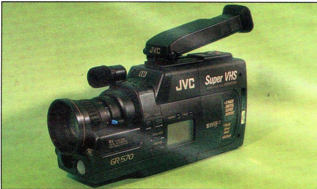
Le S-VHS dans son plus simple appareil. La base mécanique est celle du GR-66 ou du 77, premier S-VHS C de la marque, d'une ergonomie et d'une présentation assez classiques.
