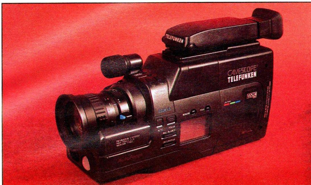
Telefunken propose avec le CM-860 un camescope au standard VHS avec ici la cassette miniature, la C. Effort intéressant de la part d'une marque d'origine allemande, du groupe Thomson il est vrai, les textes du viseur et de l'appareil sont en français et la vidéo composite sort en SECAM à l'heure où le PAL se généralise...
