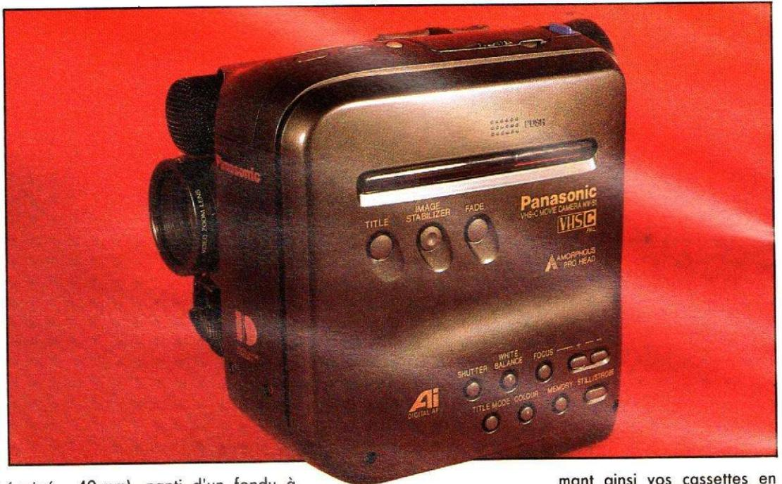
780 grammes nu, 994 équipé de sa batterie et gavé d'une cassette VHS-C, le NV-S1E est un prodige de compacité : le viseur a été conçu télescopique, ramenant la dimension maximale du camescope à moins de 15 cm. Pour y glisser une cassette, une pression sur « Eject » fera se désolidariser toute la face latérale du camescope ; l'occasion de jeter un coup d'œil sur l'intégralité de la mécanique (l'horlogerie), ainsi que sur le tambour à quatre têtes logé dans le bas de l'appareil.
