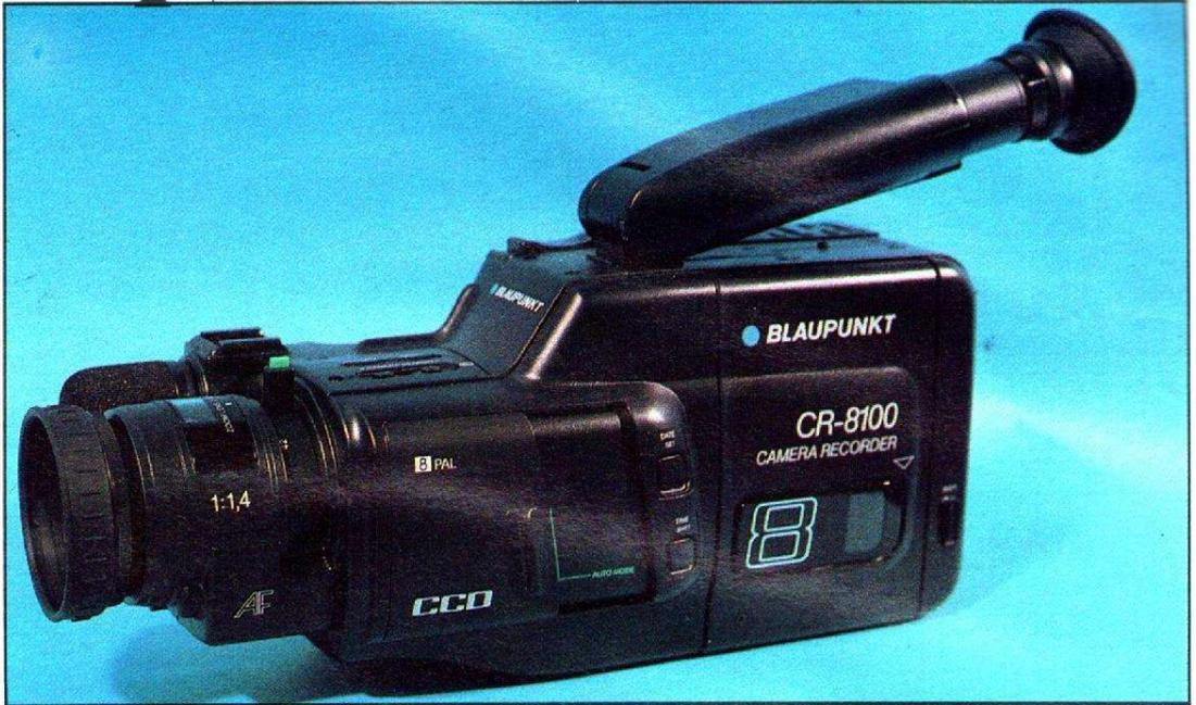
Un caméscope classique et simple à utiliser. Un volet encliquetable protège l'appareil contre les fausses manœuvres. Il est présenté dans un coffret de couleur noire, la batterie d'alimentation est située à l'arrière et dépasse légèrement du coffret. Agréable à tenir à la main, on s'habitue rapidement à accéder aux touches essentielles à la prise de vue. C'est un 8 mm avec sortie vidéo aux normes PAL et son mono mais FM.
