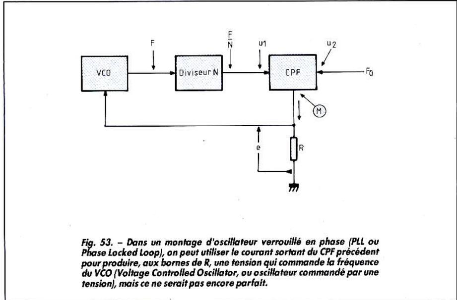
Fig. 53. - Dans un montage d'oscillateur verrouillé en phase (PLL ou Phase Locked Loop), on peut utiliser le courant sortant du CPF précédent pour produire, aux bornes de  $R$ , une tension qui commande la fréquence du VCO (Voltage Controlled Oscillator, ou oscillateur commandé par une tension), mais ce ne serait pas encore parfait.
