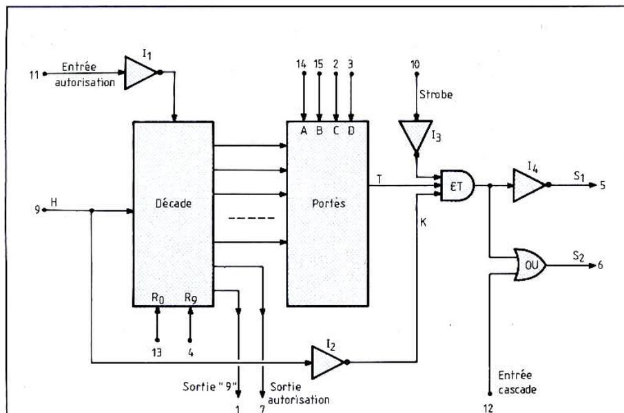
Fig. 55. - Structure simplifiée du « multiplicateur de régime » HEF 4527, comprenant une « décade » à quatre basculeurs, que l'on peut remettre à 0 par  $R_0$  et à 9 par  $R_9$ , et qui ne peut compter les impulsions d'horloge que quand l'entrée d'autorisation (11) est au niveau bas. Elle commande un jeu de portes, « programmé » par le nombre binaire appliqué en  $A$ ,  $B$ ,  $C$  et  $D$ , qui délivre un signal  $T$ , autorisant le passage de certaines impulsions  $K$  par le circuit ET.
