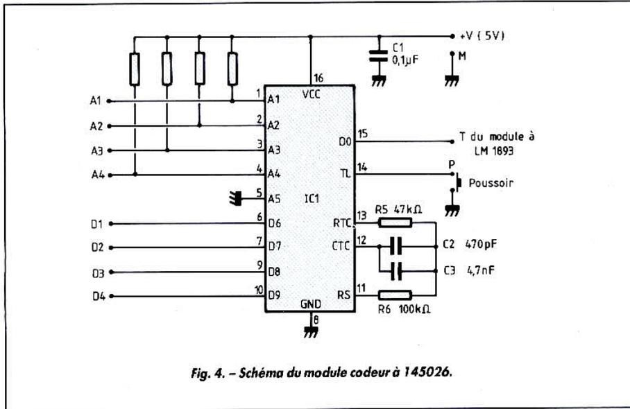
Fig. 4. - Schéma du module codeur à 145026.
