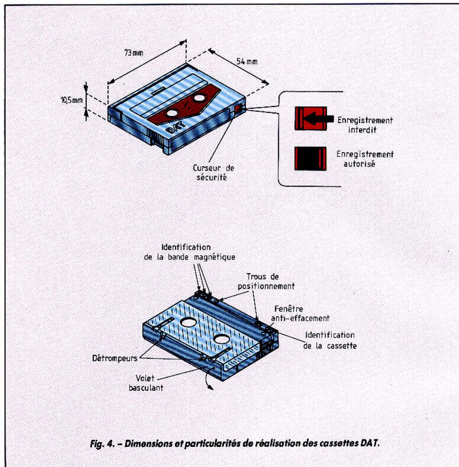
Fig. 4. – Dimensions et particularités de réalisation des cassettes DAT.
