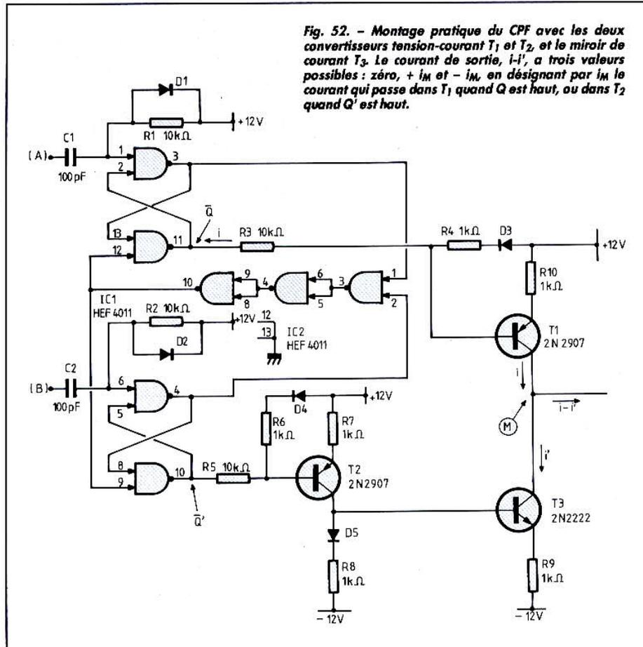
Fig. 52. - Montage pratique du CPF avec les deux convertisseurs tension-courant  $T_1$  et  $T_2$ , et le miroir de courant  $T_3$ . Le courant de sortie,  $i-i'$ , a trois valeurs possibles : zéro,  $+i_M$  et  $-i_M$ , en désignant par  $i_M$  le courant qui passe dans  $T_1$  quand  $Q$  est haut, ou dans  $T_2$  quand  $Q'$  est haut.
