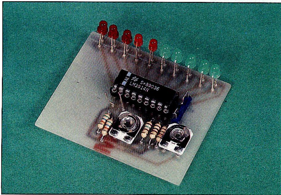
Les bornes 4 et 6 sont polarisées par les résistances et les potentiomètres, la tension de référence du voltmètre est déterminée par P<sub>2</sub> et R<sub>5</sub>, P<sub>1</sub> ajuste la « distance électrique » entre les diodes, ici 0,1 V, compte tenu du diviseur par deux installé à l'entrée, on devra mesurer, entre 6 et 7, une tension de 0,5 V. La tension sur 8 sera ajustée à la
