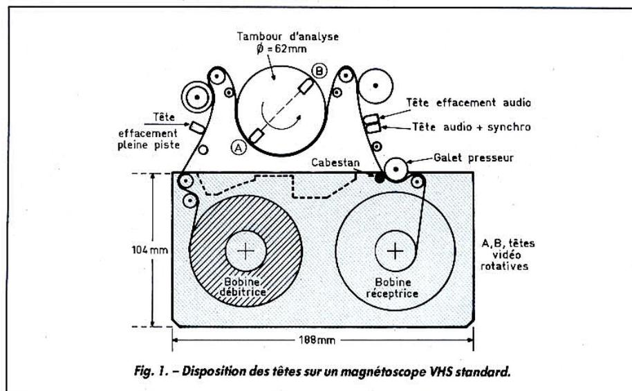
Fig. 1. - Disposition des têtes sur un magnétoscope VHS standard.
