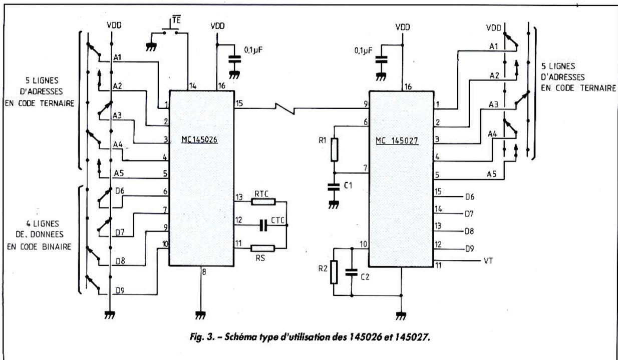
Fig. 3. - Schéma type d'utilisation des 145026 et 145027.
