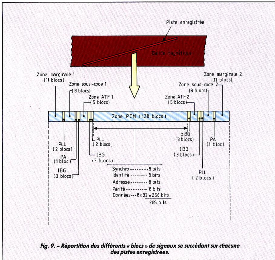
Fig. 9. - Répartition des différents « blocs » de signaux se succédant sur chacune des pistes enregistrées.
