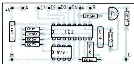
Fig. 11. - Implantation des composants sur le module décodeur.
