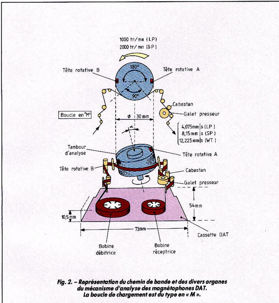
Fig. 2. - Représentation du chemin de bande et des divers organes du mécanisme d'analyse des magnétophones DAT. La boucle de chargement est du type en « M ».
