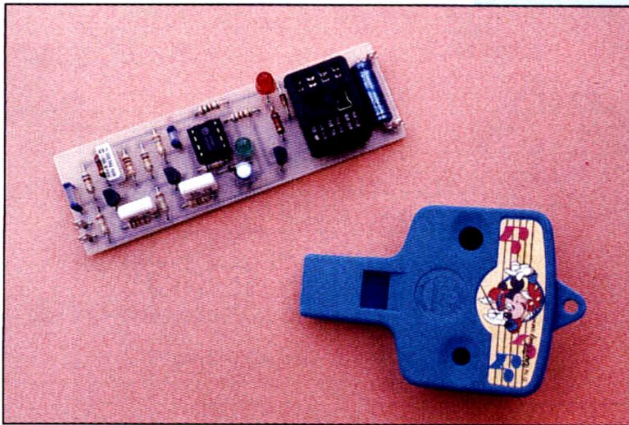
Un comparateur de fréquence se charge de déclencher une bascule dès que la fréquence du signal appliqué au circuit tombe dans cette plage. La sortie de cette bascule commande, dans notre cas, un transistor à grand grain qui fait coller un relais et allumer une LED. Prévu pour être intégré dans des jouets, des porte-clés ou
