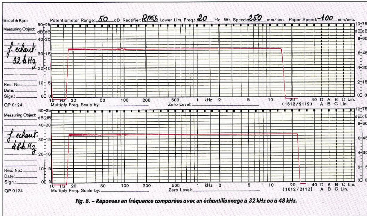
Fig. 8. - Réponses en fréquence comparées avec un échantillonnage à 32 kHz ou à 48 kHz.
