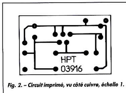
Fig. 2. - Circuit imprimé, vu côté cuivre, échelle 1.
