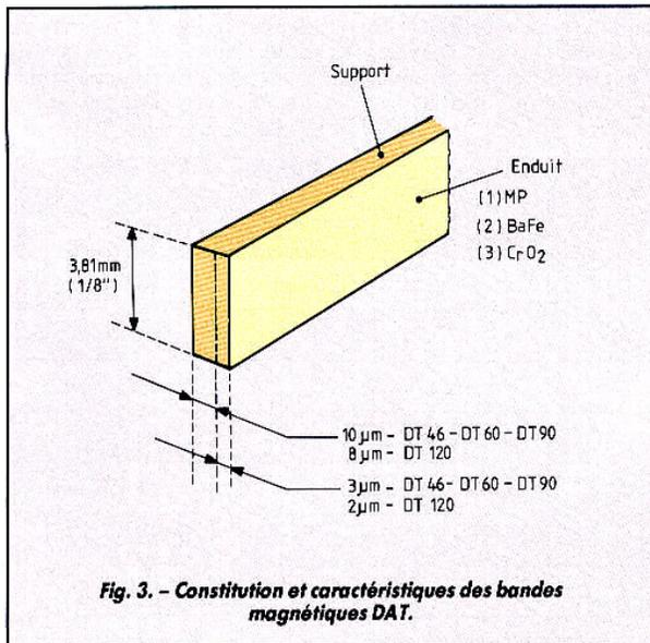
Fig. 3. - Constitution et caractéristiques des bandes magnétiques DAT.
