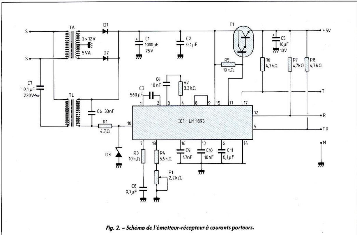
Fig. 2. - Schéma de l'émetteur-récepteur à courants porteurs.
