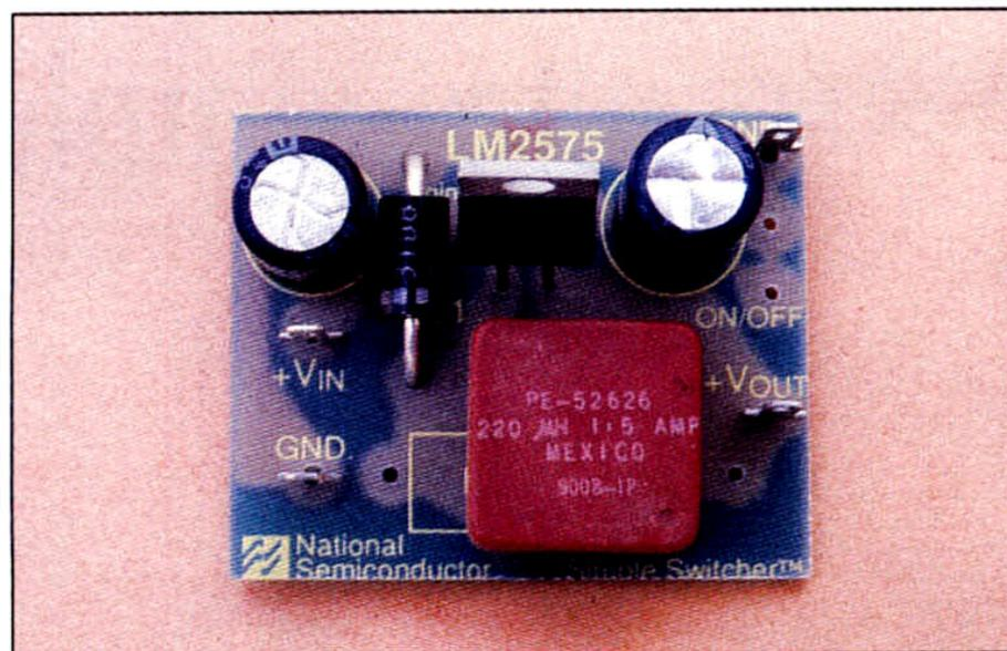
soudure réalisée. La version 5 V admet de 7 à 35 V en entrée, la version 12 V de 15 à 35 V en entrée et la version 15 V de 18 à 35 V. Comme vous pourrez le constater très vite, même pour des courants de sortie importants et des tensions d'entrée élevées, le régulateur ne chauffe quasiment pas et, en tout cas, nettement moins que son homologue linéaire dans la même situation.
