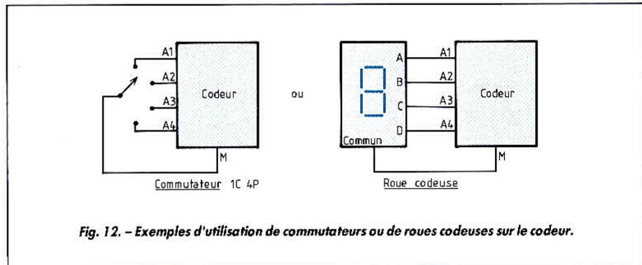
Fig. 12. - Exemples d'utilisation de commutateurs ou de roues codeuses sur le codeur.
