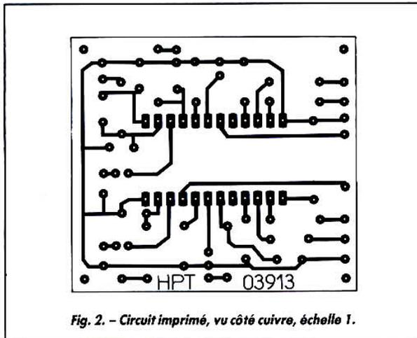
Fig. 2. - Circuit imprimé, vu côté cuivre, échelle 1.
