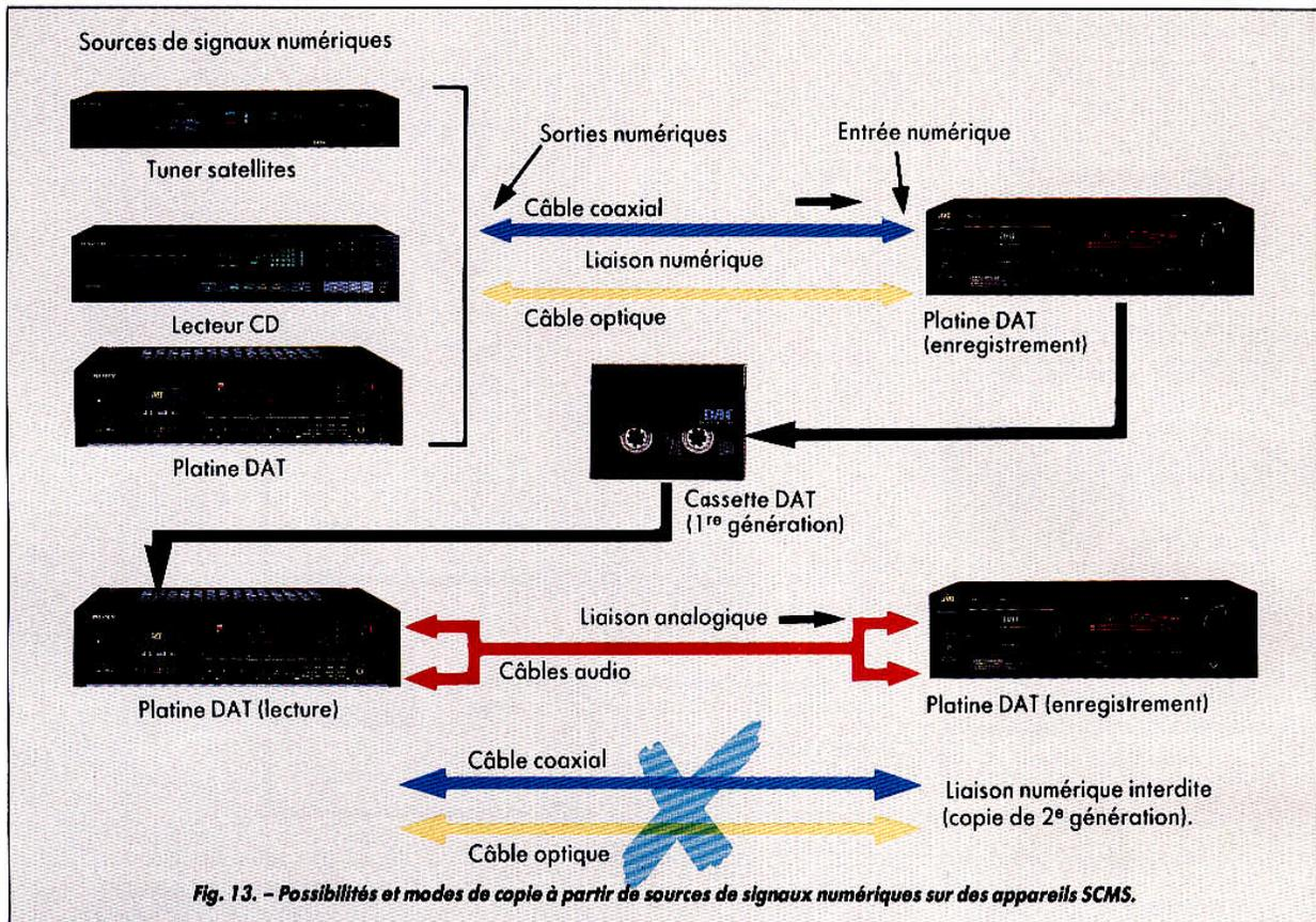
Fig. 13. - Possibilités et modes de copie à partir de sources de signaux numériques sur des appareils SCMS.
