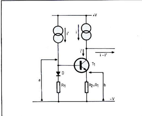
Fig. 51. - Le transistor  $T_1$  est monté ici en « miroir de courant », il permet de « recopier », sur son collecteur, le courant  $i'$  (mais il s'agit alors d'une source qui consomme ce courant et non d'une source qui le fournit). On peut alors obtenir facilement un courant qui soit la différence  $i-i'$ .
