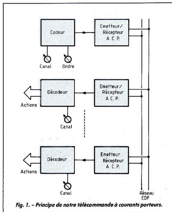
Fig. 1. - Principe de notre télécommande à courants porteurs.
