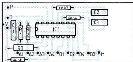
Fig. 10. - Implantation des composants sur le module codeur.
