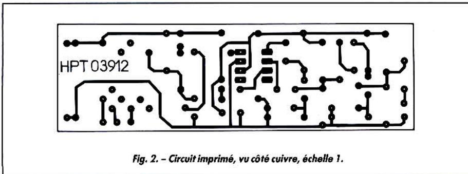
Fig. 2. - Circuit imprimé, vu côté cuivre, échelle 1.
