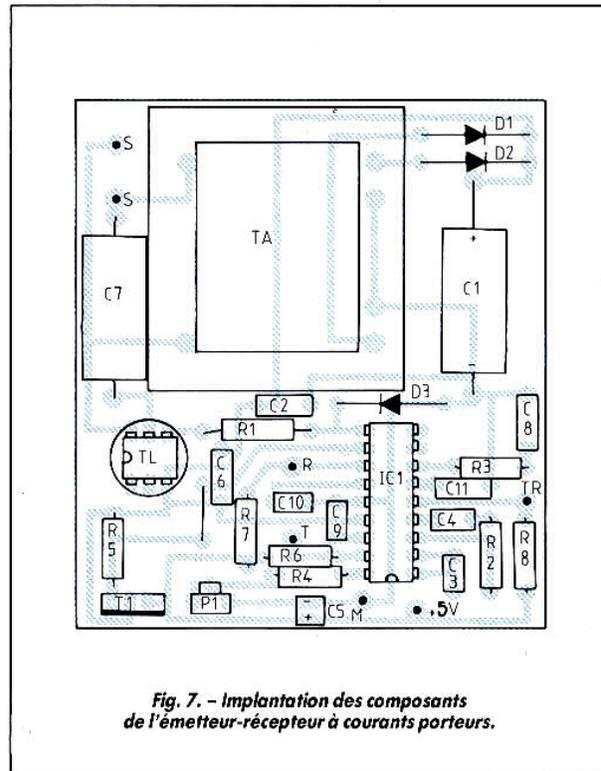
Fig. 7. - Implantation des composants de l'émetteur-récepteur à courants porteurs.
