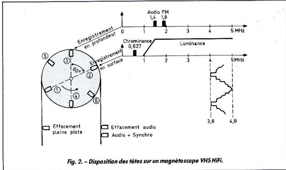
Fig. 2. - Disposition des têtes sur un magnéscope VHS HiFi.
