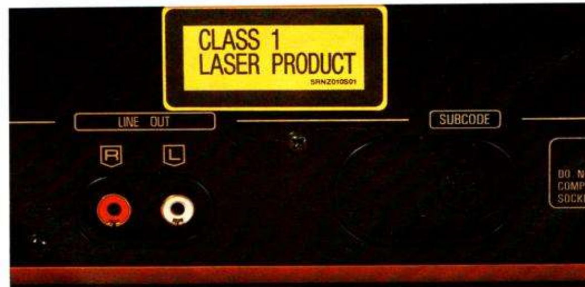
Photo 2. - Attention laser ! À côté des prises RCA audio, une prise multiple d'où pourra sortir un signal numérique pour de futures extensions.
