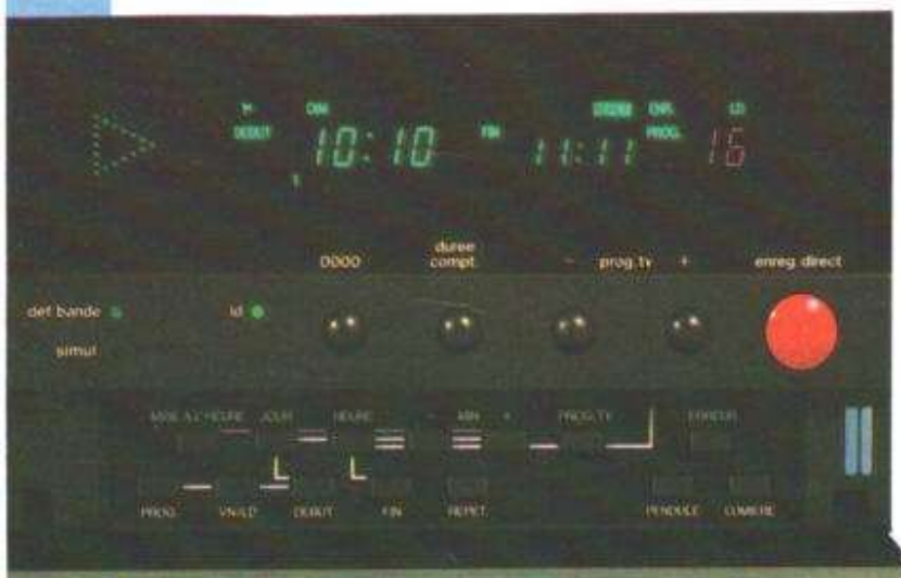
Photo 2. - Un point rouge sous l'afficheur : le bouton d'enregistrement instantané.
