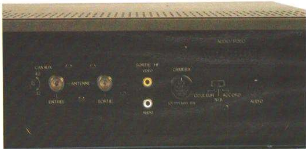
Photo 3. - Un panneau arrière très complet avec prise pour caméra.
