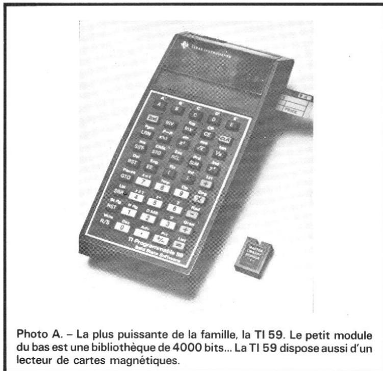
Photo A. - La plus puissante de la famille, la TI 59. Le petit module du bas est une bibliothèque de 4000 bits... La TI 59 dispose aussi d'un lecteur de cartes magnétiques.
