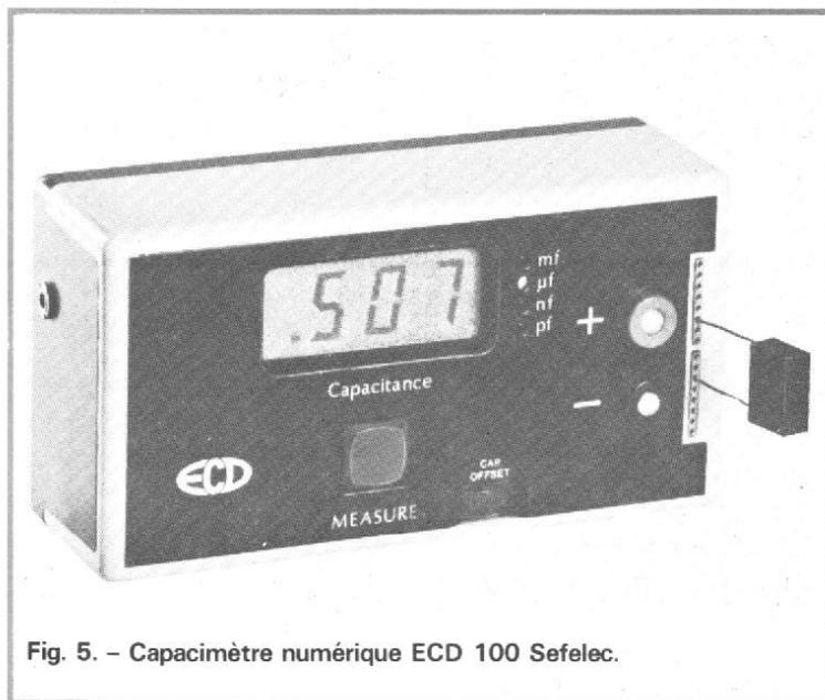
Fig. 5. - Capacimètre numérique ECD 100 Sefelec.
