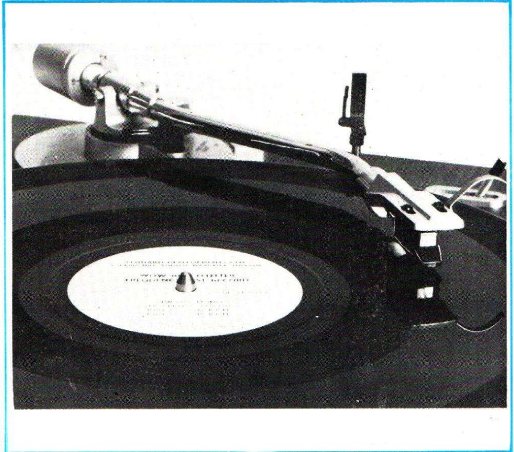
plus grand ralentissement étant celui obtenu en plaçant le balai en périphérie. La fréquence mesurée passe à 3 158 Hz au lieu des 4 150 nominaux à 33 t/mn. A 45 t/mn, la variation de vitesse est plus faible, fréquence mesurée: 3 166 Hz. Un écart de vitesse de 2,5 pour mille à 33 t/mn et de 0,5% à 45 t/mn.
