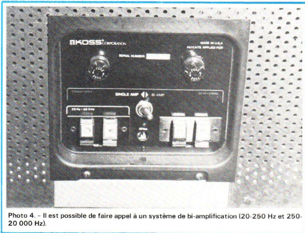
Photo 4. - Il est possible de faire appel à un système de bi-amplification (20-250 Hz et 250-20 000 Hz).
