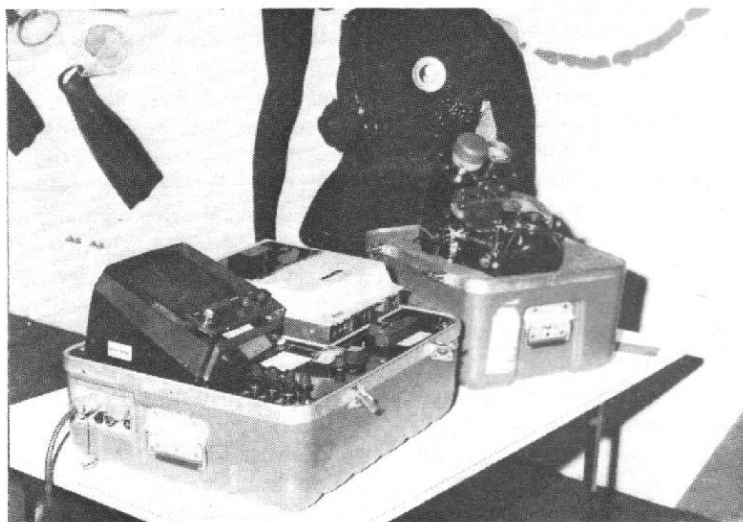
Photo 2. - Equipement vidéo sous-marin. A droite, le casque équipé d'une caméra.
