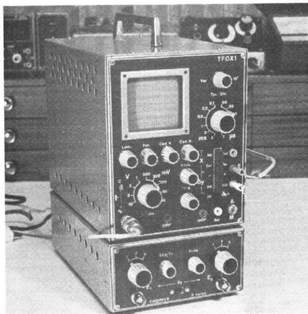
Photo H. - La conception mécanique retenue permet de former avec le TFOX1 un bloc compact occupant un minimum de place.
