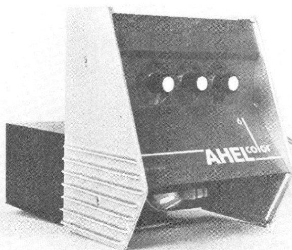
Fig. 4. - Les trois boutons, dont les graduations sont éclairées par transparence, commandent l'introduction progressive des trois filtres dichroïques. A la base, on aperçoit le réflecteur de la lampe basse tension.
