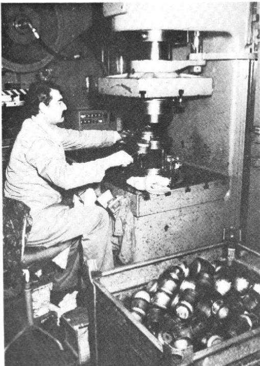
Photo 6. - La presse de 100 tonnes qui emboutit les rotors.
