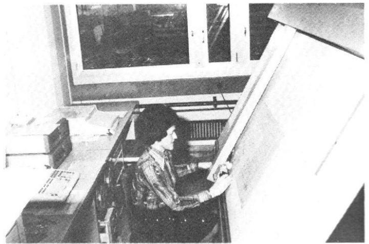
Photo 2. - La machine à dessiner les circuits imprimés, assistée par ordinateur.
