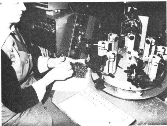
Photo 11. - Bobinage des têtes.
