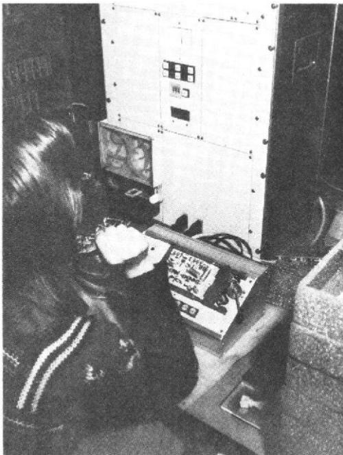
Photo 19. - Contrôle de module sur machine pilotée par bande perforée.
