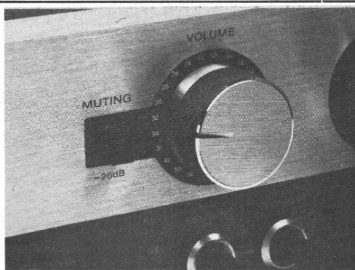
Photo 1. - Le bouton de réglage du niveau, gradué en dB - A sa gauche, l'interrupteur de « muting », - 20 dB.
