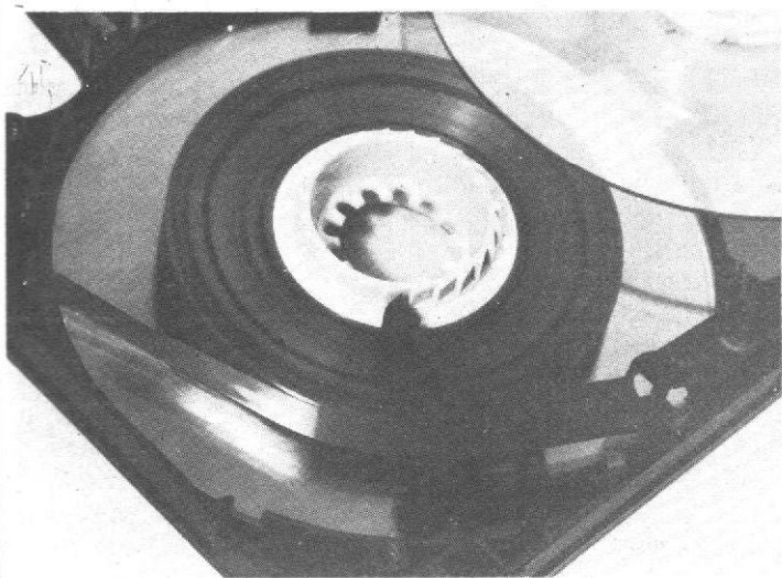
Photo D. - Le système de blocage des bobines.
