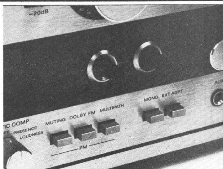
Photo 2. - Dans le bandeau noir : les clés de sélection des magnétophones, en bas, les sélecteurs du tuner : Dolby, réception multiples, silencieux.
