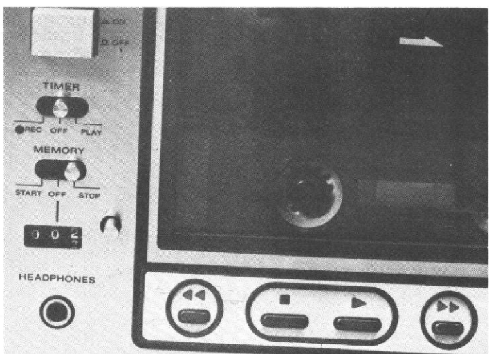
Photo G. – Compteur, présélection pour démarrage automatique et touches électromagnétiques.
