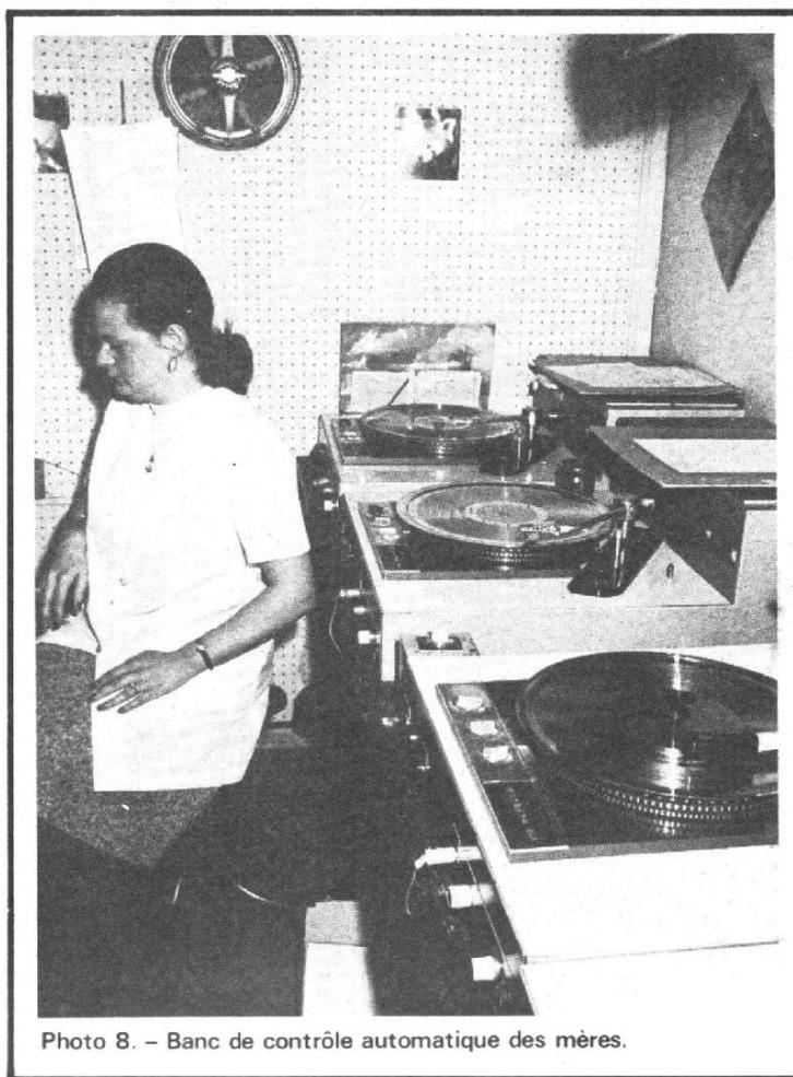
Photo 8. - Banc de contrôle automatique des mères.
