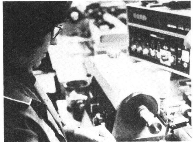
Photo G. - Le bobinage des enroulements.
