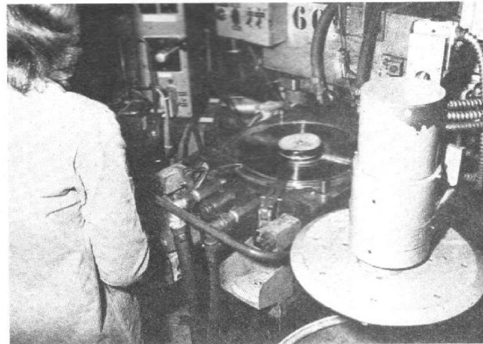
Photo 14. - Une presse semi-automatique, une opératrice met en place les étiquettes que l'on voit ici de part et d'autre du pain de matière plastique.
