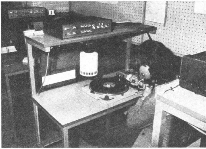
Photo 16. - Contrôle d'écoute au casque, c'est un contrôle faisant partie de l'unité de fabrication, les disques sont pris sur les machines.
