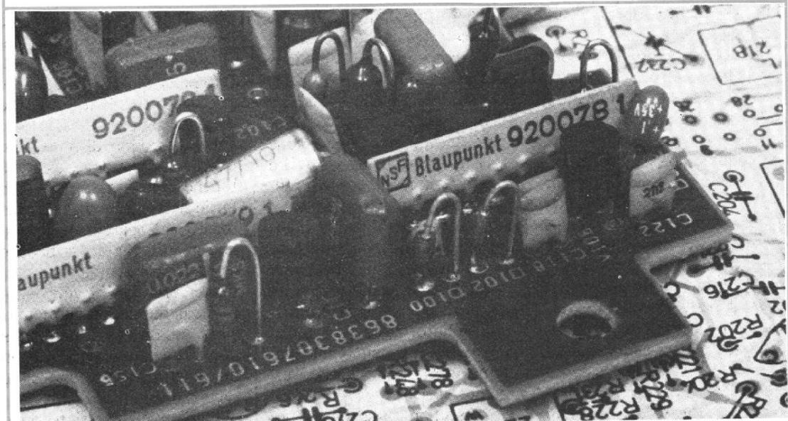
Photo 2. - Réseaux de résistances sur circuit hybride.
