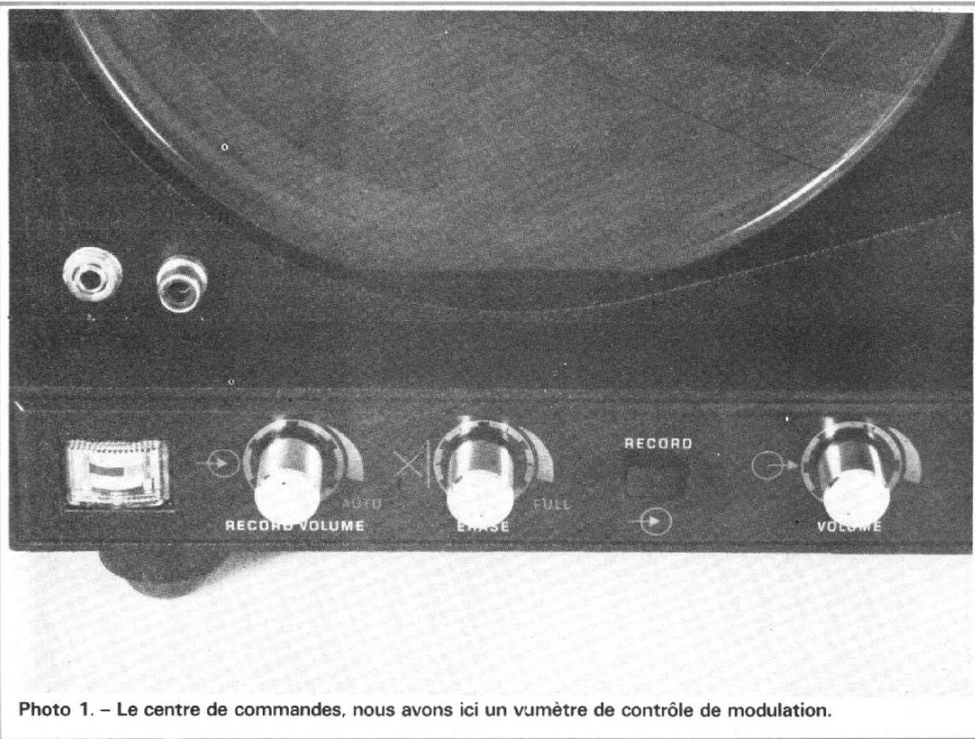
Photo 1. - Le centre de commandes, nous avons ici un vumètre de contrôle de modulation.
