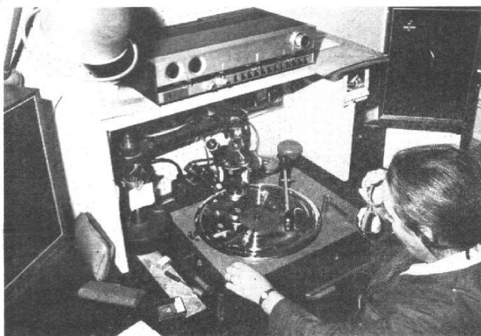
Photo 7. - Contrôle d'une mère et éventuel ébavurage manuel au microscope.
