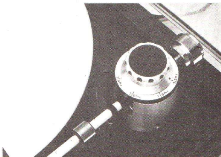
Photo 5. – L'articulation du bras de la BD 3, avec réglage de l'anti-skating de la force d'appui.
