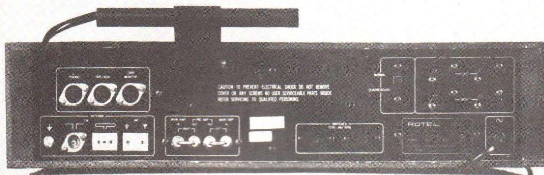
Photo 3. - Vue arrière du RX 402 avec ses prises DIN pour les haut-parleurs et les entrées. L'antenne MA a ici été relevée.
