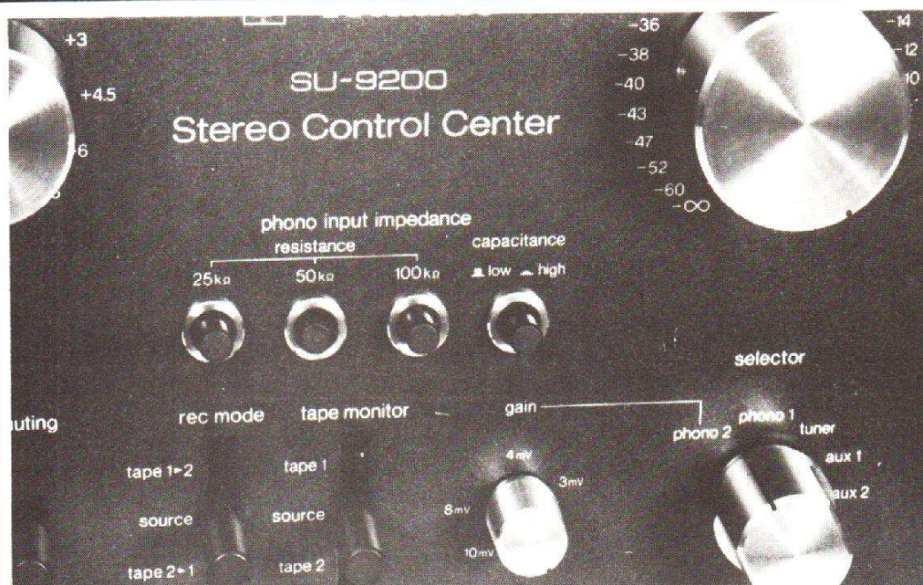
Photo 2. - Les commandes d'entrée phono sont plus complexes que celles de beaucoup d'appareils. Ici, on peut choisir l'impédance et la capacité d'entrée ainsi que, pour une entrée, la sensibilité.
