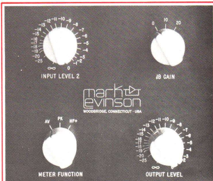
Photo 5. - Des boutons qui tiennent bien en main, une gravure manuelle, des indications précises. Dans le bas, à gauche, le commutateur du Vumètre avec trois types d'indications, moyenne, de crête, et crête avec préaccentuation HF.
