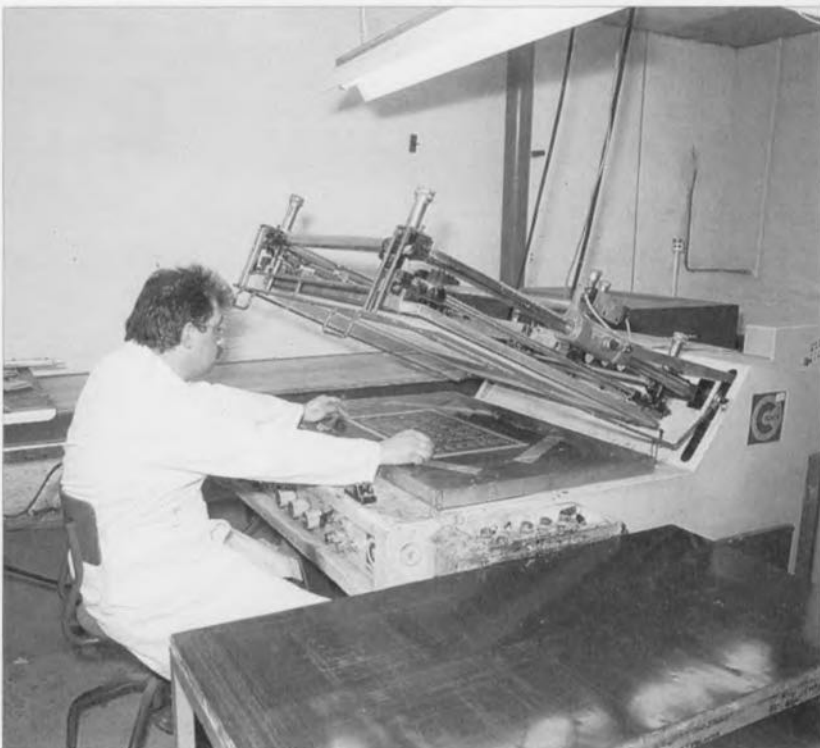
Figure 5. On superpose, par procédé sérigraphique, le texte de la sérigraphie sur le masque de soudure.
