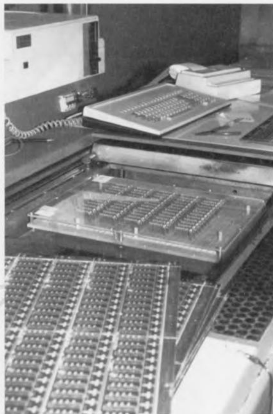
Figure 6. Au cours du contrôle final on procède à la vérification de la présence effective de toutes les connexions électriques prévues.
