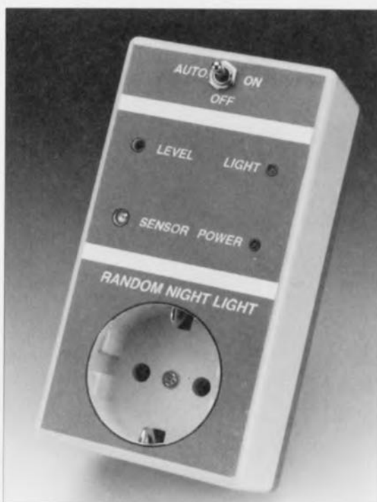
Figure 6. Notre prototype n'ira pas dormir dans un tiroir ! Il faudra bien entendu que le capteur de lumière diurne puisse « jeter un coup d'oeil » vers l'extérieur, ce qui implique qu'on choisira de préférence de le positionner à proximité d'une fenêtre ouverte sur le monde.
