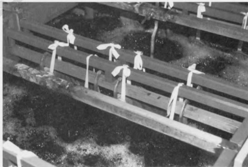
Figure 3. L'épaissement électrolytique de la couche de cuivre se fait dans des bacs de dimensions imposantes. Les vapeurs nées au cours de ce processus sont aspirées pour être évacuées, les métaux solubilisés sont extraits des résidus chimiques liquides (par une société de recyclage).
