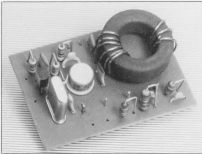
travail par la prise en série avec C2 d'un condensateur ajustable de 150 pF, garantit une fréquence de transmission stable.
