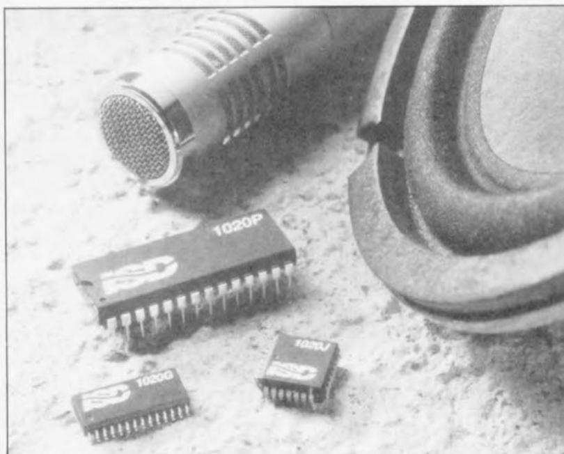
**Le fabricant californien de semi-conducteurs Information Storage Devices (ISD) propose une famille inédite et complète de composants destinés au stockage de signaux vocaux (c'est-à-dire de paroles ou autres éléments sonores). Il s'agit de la famille ISD-10xx, composée de 3 circuits intégrés, se caractérisant chacun par une durée d'enregistrement, une fréquence de balayage et une fréquence de coupure haute du signal audio (BF) propres (voir tableau 1).**
