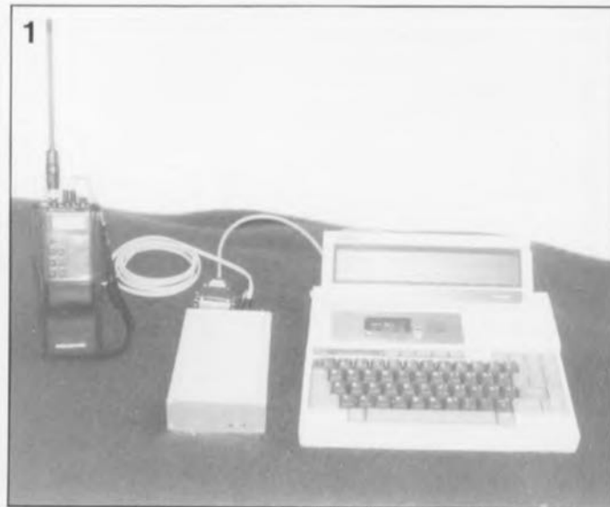
Figure 1. Station Packet Radio comportant un émetteur/récepteur portatif, un modem TNC et un ordinateur portatif.
