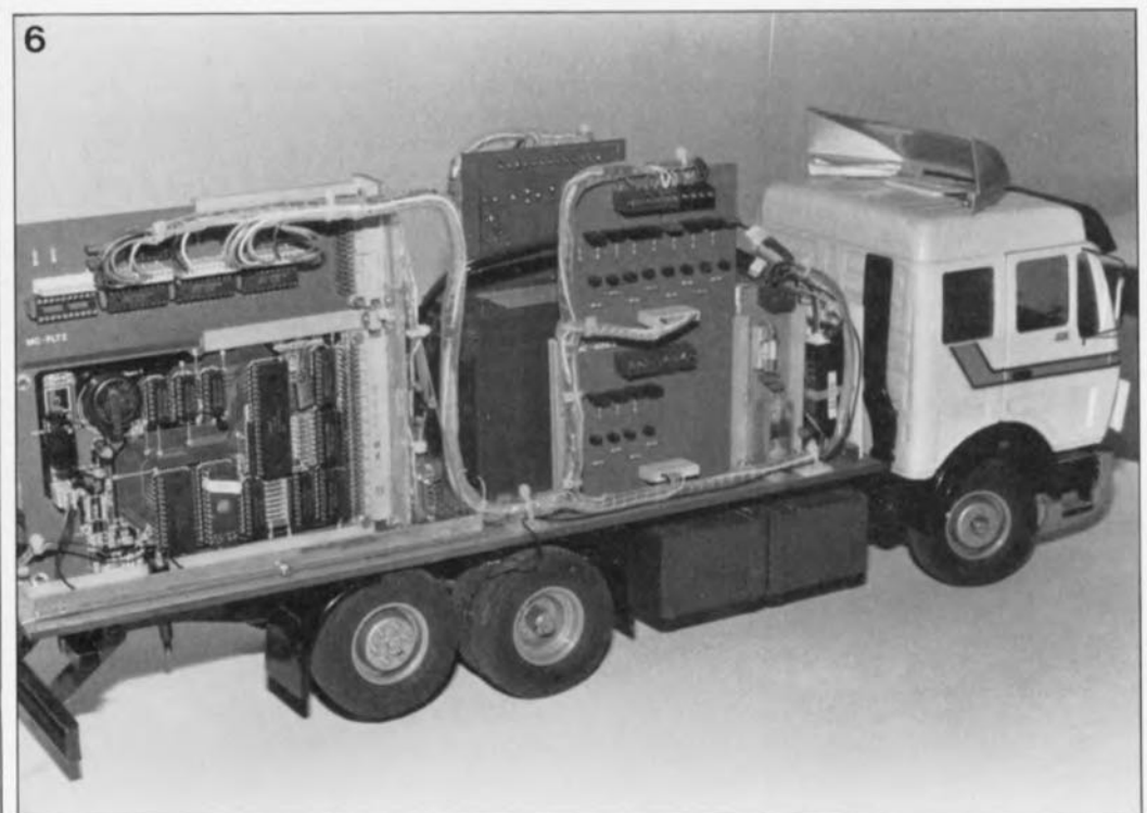
Figure 6. Un SIMCAD "mobile". Un modéliste "poids lourds", W.Otten, fait appel au SIMCAD non seulement pour commander l'éclairage, les clignotants et la boîte mécanique à 3 vitesses de son camion, mais aussi pour en abaisser l'essieu arrière en charge et manoeuvrer la fourche d'attelage.
