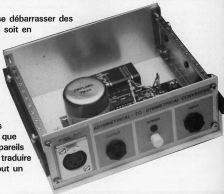
Dans l'électronique audio, il est fréquent que l'on utilise, simultanément, et des amplificateurs, et des tables de mixage et toute sorte d'autres instruments, dotés chacun d'une ligne de terre, reliée au contact de terre d'une prise secteur. Comme le montre la **figure 1a**, ce genre de "toile d'araignée" peut entraîner l'apparition éventuelle d'une, voire de plusieurs, boucle(s) de ronflement (dite de masse).
