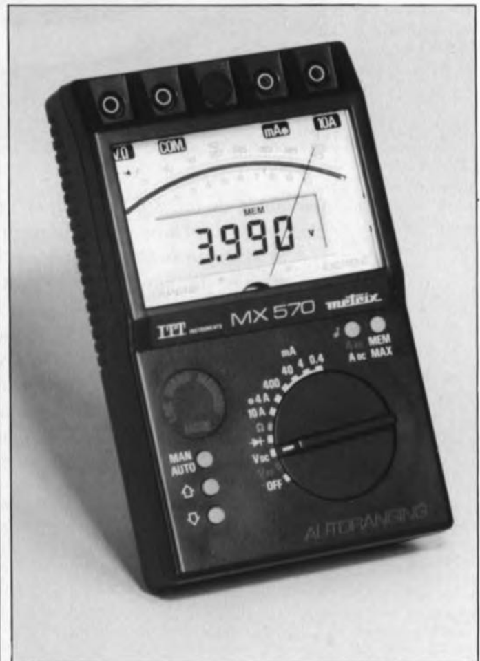
Les multimètres les plus modernes comportent une échelle numérique et une échelle analogique
