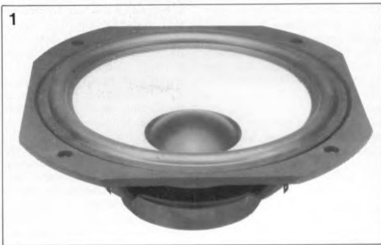
Figure 1. Le haut-parleur utilisé dans le caisson de graves est un exemplaire tout neuf de la marque française Focal: le 10V516. Il est doté d'une membrane en Polyglass et d'une bobine de grande longueur.
