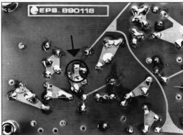
Figure 3. Un condensateur CMS de 1 nF est soudé entre les flots de soudure de la résistance R3.
