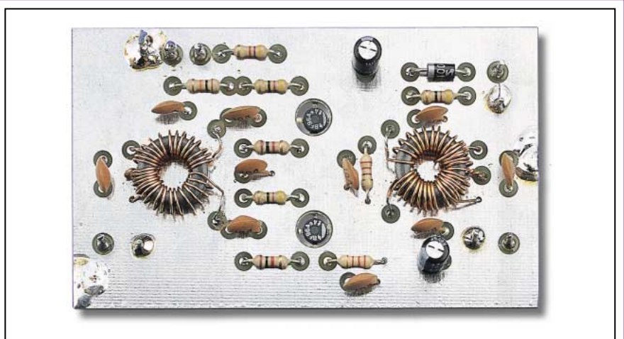
Figure 7 : Photo du préamplificateur d'antenne monté sur un circuit imprimé double face. Les deux MOSFET doivent être soudés sur le côté opposé du circuit imprimé, comme vous pouvez le voir sur la figure 10.
