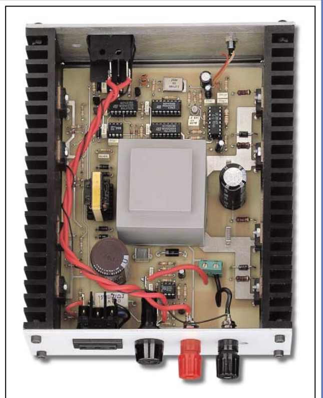
Figure 13 : Vue du convertisseur depuis l'arrière. La prise de sortie pour la tension 220 volts, est insérée en force dans la découpe rectangulaire présente sur la gauche du panneau.
