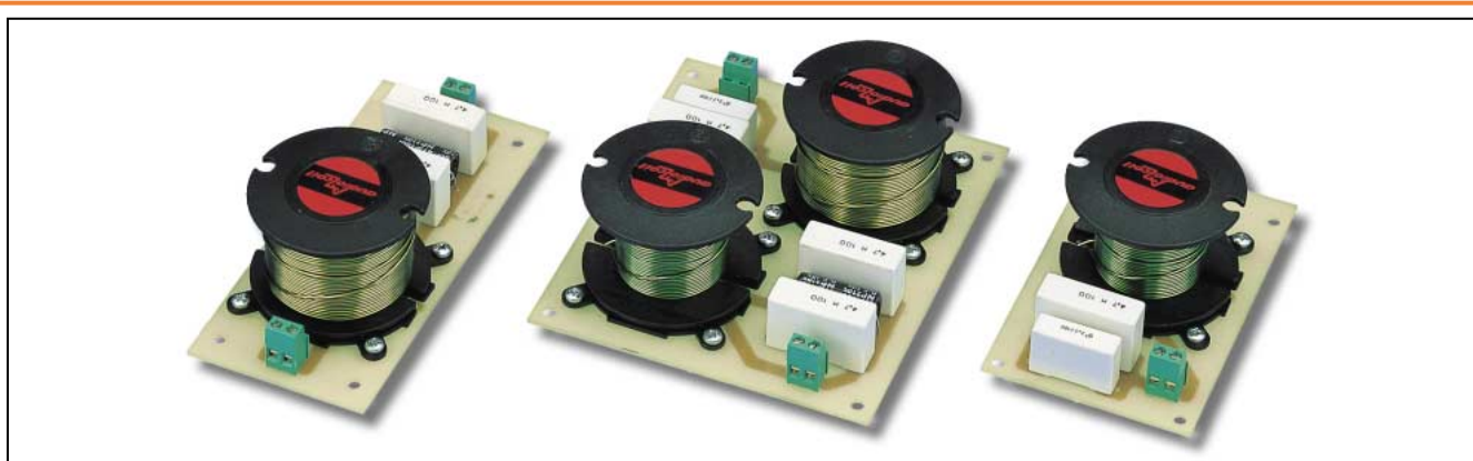
Figure 24 : Tous les filtres à 3 voies sont composés de trois étages séparés. L'un destiné au "tweeter", le second au "médium" et le dernier au "woofer".
