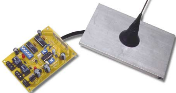
Figure 11 : L'émetteur de radiocommande équipé d'une antenne AS433.
