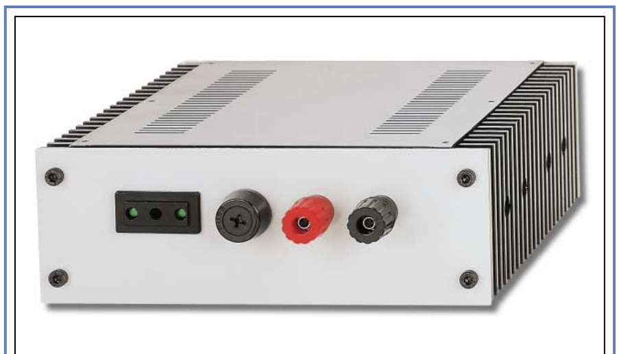
Figure 2 : Sur la photo de début d'article, vous pouvez voir le panneau avant du coffret du convertisseur. Sur cette photo, vous pouvez voir la partie arrière, où sont fixés, la prise de sortie 220 volts, les deux douilles d'entrée 12 volts et le porte-fusible.
