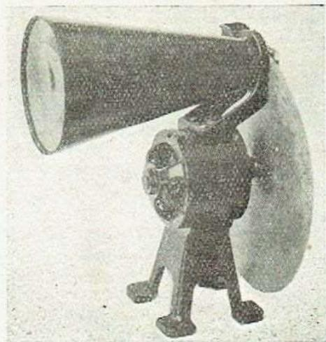
Fig. 4. — Récepteur à disque.
