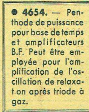
● 4654. — Penthode de puissance pour base de temps et amplificateurs B.F. Peut être employée pour l'amplification de l'oscillation de relaxation après triode à gaz.
