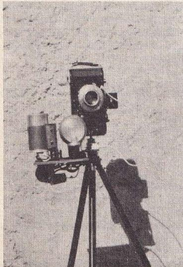
Fig. 5. — Le flash électronique en ordre de marche; il ne reste plus qu'à y brancher le cordon (amovible) de l'alimentation
