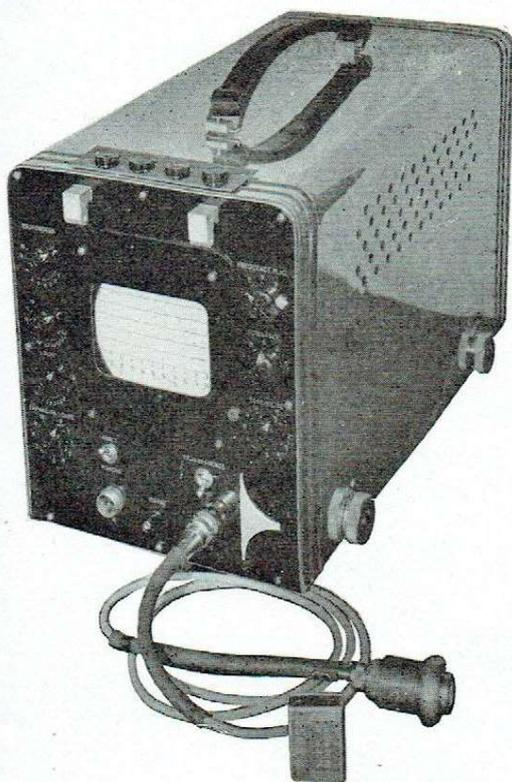
Le « Métalloradar » type L d'Ultrasonic utilise les ultrasons pour la détection des défauts internes dans les pièces mécaniques.
