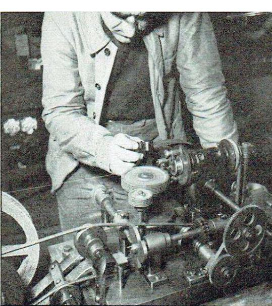
Fabrication, par étirage, des filaments spiralés de tubes redresseurs.
