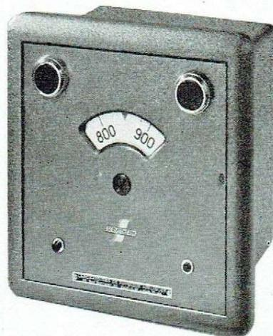
Le « Servotherm » des Laboratoires de Physique Appliquée est un régulateur de température à amplification magnétique.
