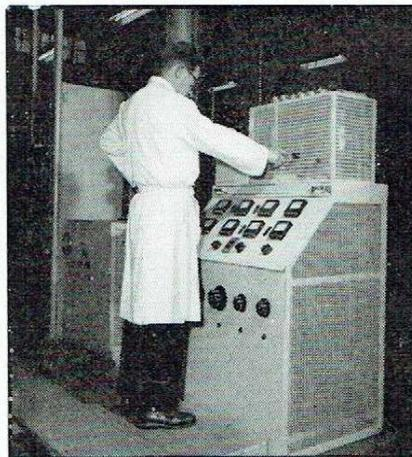
Poste d'essais dynamiques de tubes émetteurs de petite et moyenne puissance.
