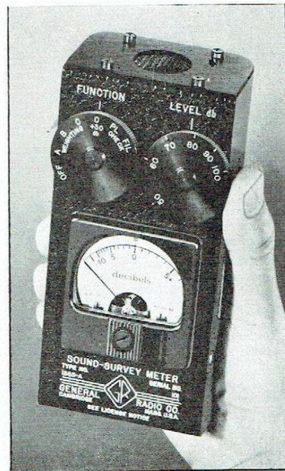
Le Sonomètre 1555-A de **General Radio**, importé par **Radiophon**, est alimenté par piles et mesure les bruits de 40 à 8 000 Hz entre 40 — et 136 dB, à  $\pm 1$  dB. —
