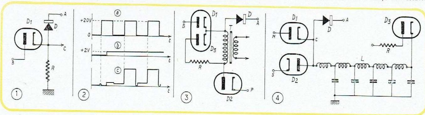
L'amplificateur utilise la conductibilité inverse d'un cristal pendant le temps de disparition des porteurs
