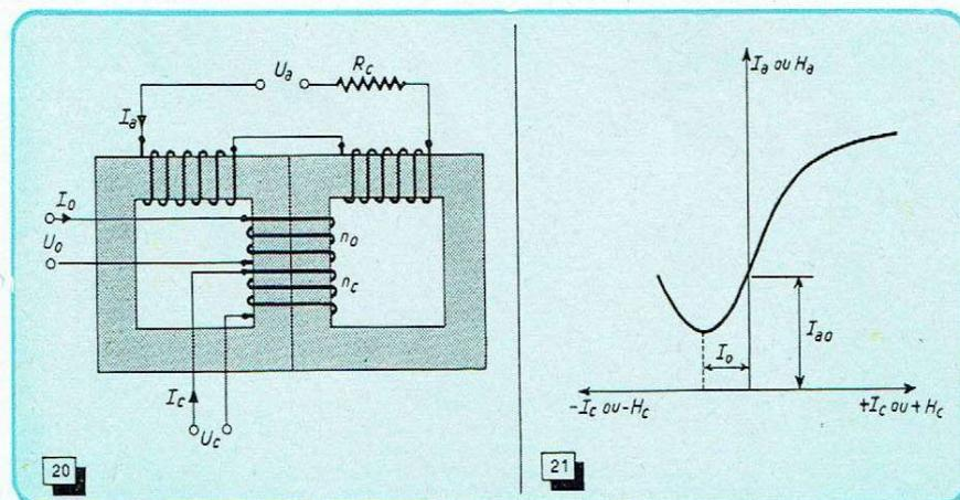
Fig. 20. — Amplificateur magnétique à inductances avec suraimantation initiale.
