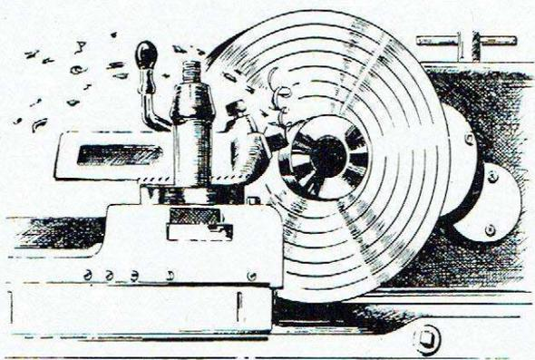
C'est un enregistrement magnétique qui commande le mouvement de l'outil du tour ainsi que la vitesse de coupe de manière à obtenir une pièce de la forme voulue. C'est un excellent exemple de « programme magnétique » pour la commande des machines-outils.
