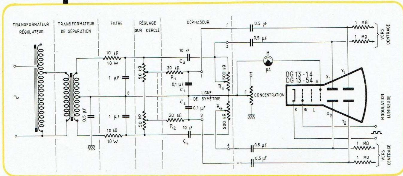
Avec un balayage par tension en dents de scie, l'axe de temps se trouve limité par le diamètre du tube; une base de temps circulaire permet, par contre, la reproduction d'une ligne environ trois fois plus longue qui, modulée en lumière, autorise la mesure des temps, la précision étant d'autant meilleure que la vitesse de balayage est plus constante, donc le cercle plus parfait.
