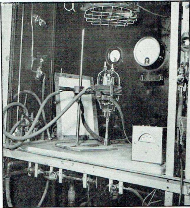
**Dégazage d'électrodes avec pompage d'un tube de 2 kW (IB 3/2 000 Philips). On voit nettement le bobinage entourant l'ampoule et parcouru par les courants H.F. qui induisent dans les électrodes des courants de Foucault provoquant leur échauffement.**
