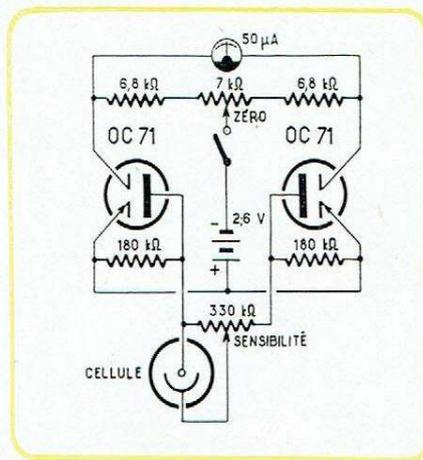
Symétrique, cet amplificateur pour cellule est protégé de l'action de la température sur les transistors.
