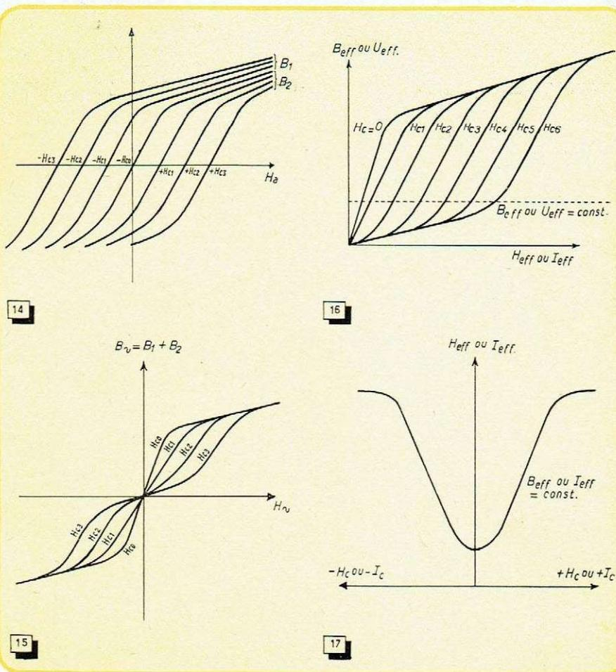
Fig. 14. — Courbes des inductions  $B_1$  et  $B_2$  en fonction du champ alternatif  $H_a$ .
