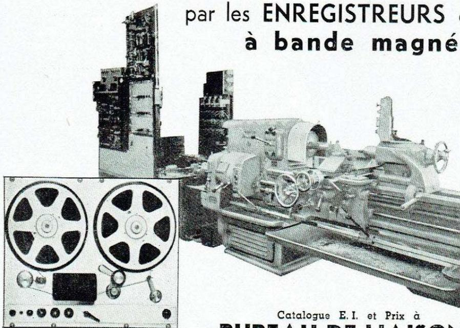
**Savez-vous que** la commande automatique et simultanée de plusieurs machines outils, assurée et contrôlée par ruban magnétique, vous permettra de reproduire en série une pièce prototype ?
