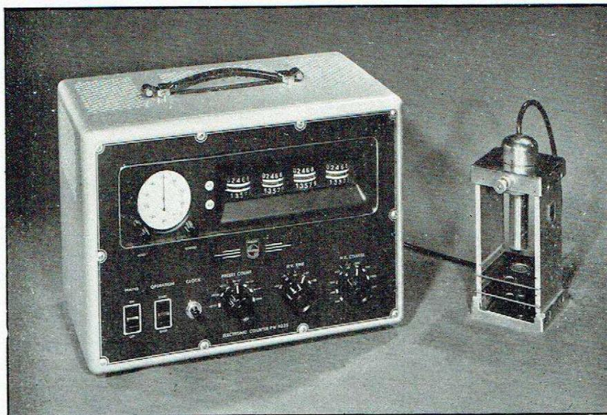
Echelle de comptage prédéterminée à tubes décimaux (Philips-Industrie type PW 4035) pour dénombrement de radiations.
