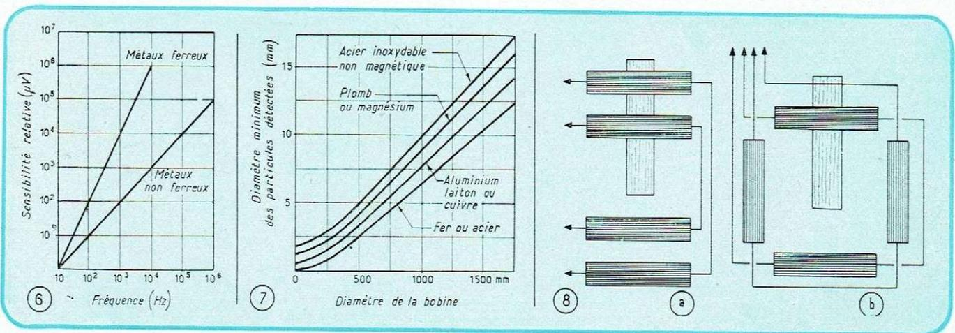
Fig. 6. — Sensibilité relative d'un détecteur de métaux en fonction de la fréquence.
