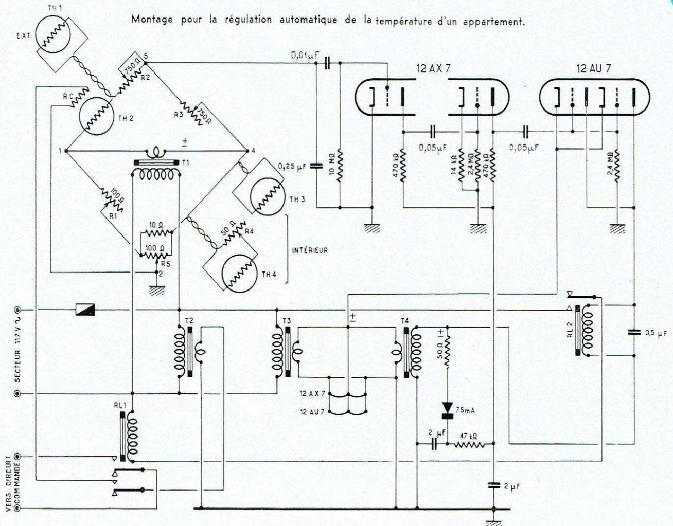
Les thermistances TH1 à TH4 sont des modèles identiques (Western Electric type 3 B), en forme de rondelles, et dont la résistance à 20° C est de l'ordre de 30 Ω et la variation de - 4 % par degré C. Les 4 transformateurs sont des modèles 110/6,3 V. Leur débit en 6,3 V peut ne pas dépasser 1 A, sauf pour T 3, qui doit pouvoir fournir 3 A. La résistance chauffante RC est un fil de nickel-chrome d'environ 6 Ω, disposé en forme de boudin au fond d'un boîtier cylin-
