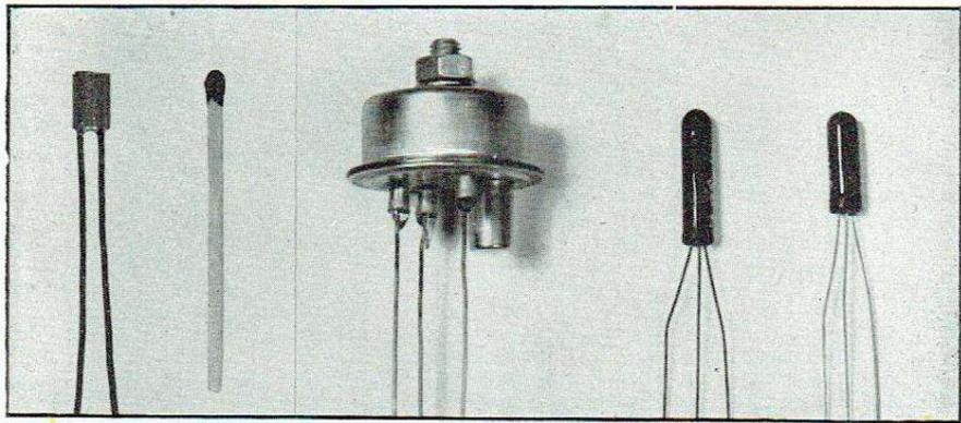
Festival stéréotronique : la nouvelle et sensationnelle photodiode à jonction de **La Radiotechnique**, en compagnie des transistors OC 15, OC 72 et OC 71 de la même fabrication.
