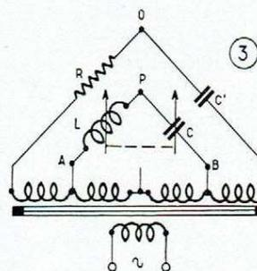
Comment on passe progressivement du montage classique (1a) capable de créer un déphasage inférieur à  $180^\circ$  à un schéma (3) permettant de dépasser largement cette valeur.
