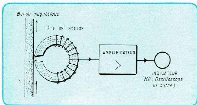
Le schéma ci-dessus représente la reproduction (ou lecture) d'un enregistrement magnétique. Dans certains cas, lorsqu'il s'agit d'un « programme » de commande de machines-outils, l'indicateur est remplacé par des dispositifs appropriés (relais sélectifs, etc.).
