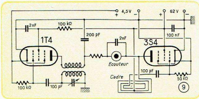
Fig. 9. — Schéma d'un détecteur portable alimenté par piles.
