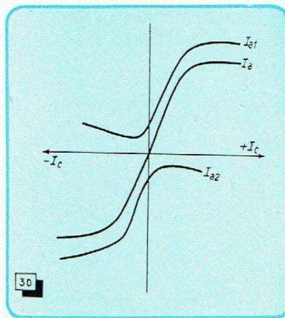
Fig. 30. — Caractéristique de commande de l'amplificateur magnétique de la figure 29.
