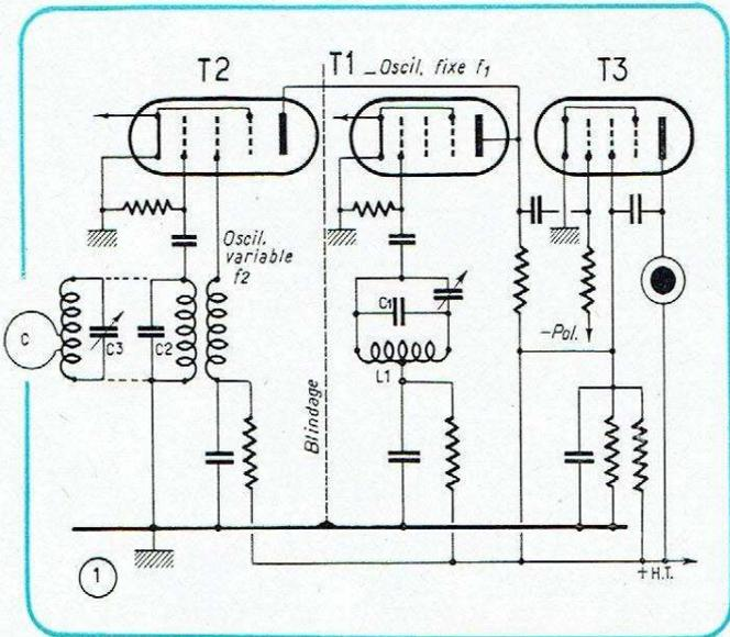
Fig. 1. — Schéma de principe d'un générateur à battements. La grille 2 de  $T_1$  doit être réunie à la droite du circuit oscillant  $L_1-C_1$ .
