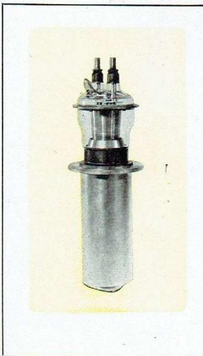
La triode **S.F.R. E 1567**, alimentée sous 8 000 V, peut fournir 15 kW H.F. pour le chauffage industriel.
