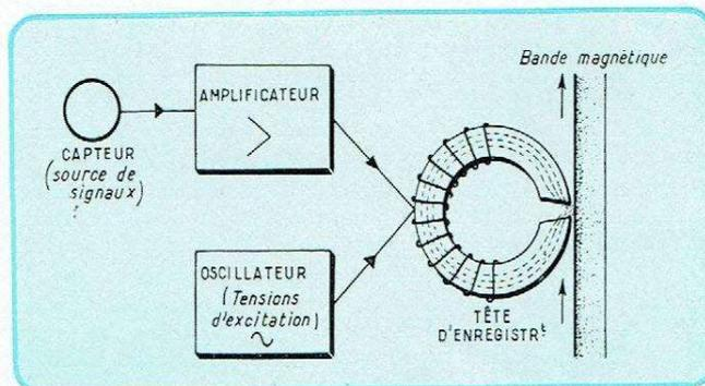
Le schéma ci-dessus représente, sous sa forme la plus générale, la méthode d'enregistrement magnétique sur bande. On remarquera que les lignes magnétiques jaillissant de l'entrefer pénètrent dans la couche magnétique recouvrant la bande.
