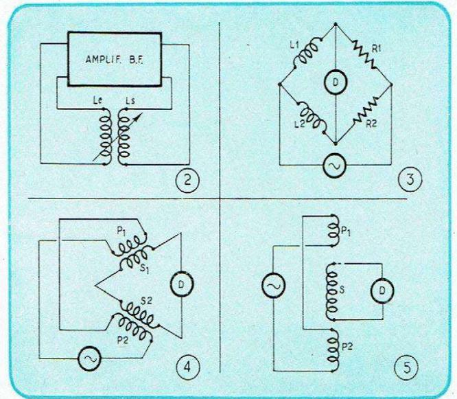
Fig. 2. — Principe du détecteur à amorçage d'oscillations.
