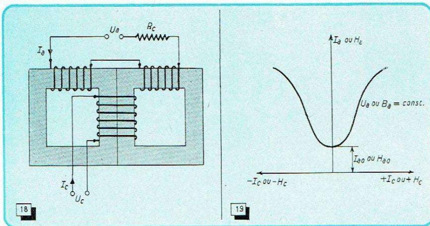
Fig. 18. — Schéma élémentaire d'un amplificateur à inductances.
