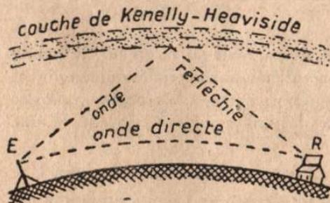
FIG. 102. — L'onde de l'émetteur E parvient à l'antenne de réception R par deux chemins différents : en suivant la surface du globe et après réflexion dans les hautes couches de l'atmosphère.
