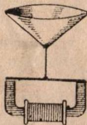
FIG. 98 (à droite). — Haut-parleur électromagnétique à palette vibrante et à diffusion de son par membrane conique.
