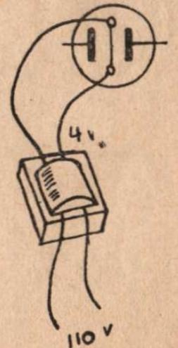
tension. Mais, le plus souvent, la tension de chauffage est obtenue à partir d'un petit enroulement secondaire placé sur le transformateur d'alimentation en plus de l'enroulement de haute tension. D'ailleurs, étant donné le courant relativement intense que doivent fournir les valves, elles sont le plus souvent à chauffage direct : c'est le filament lui-même qui sert de cathode émettrice d'électrons.
