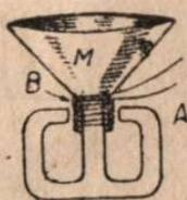
FIG. 99. — Coupe du haut-parleur électrodynamique. — A, aimant ; B, bobine mobile ; M, membrane.
