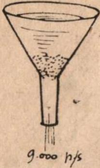
le circuit est très peu amorti (fig. 111), il ne laisse passer qu'une bande étroite de fréquences : suffisamment sélectif, il ne laisse pas passer la totalité des bandes de modulation. La courbe de résonance idéale serait rectangulaire, avec une largeur de 9000 p/s, ce qui indiquerait qu'elle laisse passer une bande de 9000 p/s et rien d'autre !
