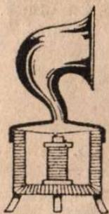
FIG. 97 (à gauche). — Coupe d'un haut-parleur électromagnétique à pavillon.
