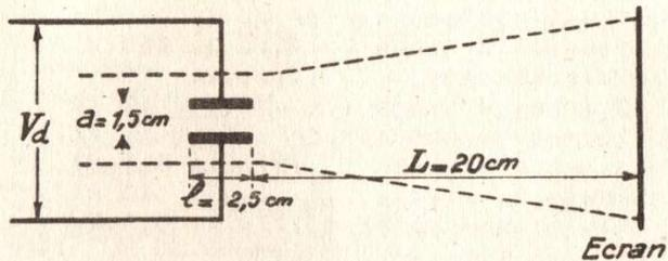
Si on applique une tension alternative sinusoïdale de 20 volts efficaces entre les plaques de déviation, on observe sur l'écran une déviation de 2 centimètres. Calculer :
