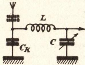
La capacité de couplage  $C_k$  se trouve placée en série avec le condensateur variable  $C$ . Il en résulte une réduction de la gamme couverte.
