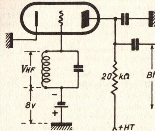
Connaissant la caractéristique dynamique  $I_p - V_g$  de ce tube et sachant que la tension HF d'entrée a une amplitude de 4 volts (modulée à 30 %), calculer graphiquement la valeur efficace de la tension BF de sortie.
