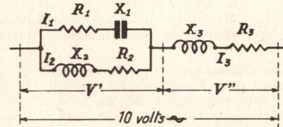
Déterminer, à l'aide du calcul imaginaire, les courants  $I_1$ ,  $I_2$  et  $I_3$ , ainsi que les tensions  $V'$  et  $V''$ .
