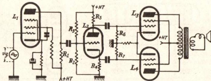
Les éléments suivants sont connus :  $R_1 - R_2 - 100\ 000$  ohms,  $R_3 - 2$  mégohms,  $R_4 - R_5 - 10\ 000$  ohms,  $R_6 = R_7 - 500\ 000$  ohms.
