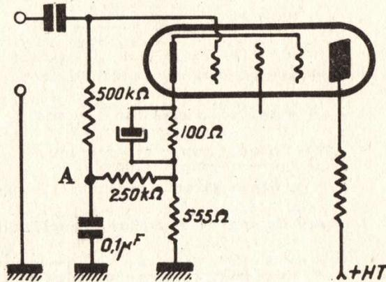
Le filtre passe-bas classique (250 kΩ; 0,1 μF) élimine au point A les variations de tension qui sont obtenues aux bornes de la résistance de 555 Ω. (1)
