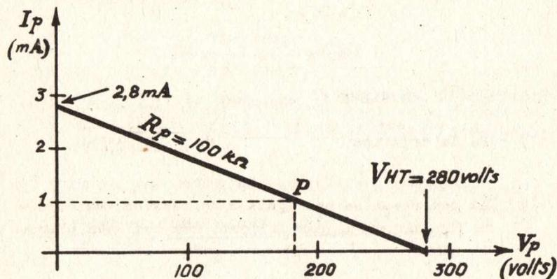
La droite de charge passe par le point de repos et par le point
