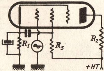
3°) - Si la haute tension est 250 volts et  $R_2 = 60\,000 \text{ ohms}$ , quelle est la tension anodique du tube.
