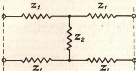
1°) - Transformer la cellule en double  $T$  en une cellule en  $T$  équivalente.
