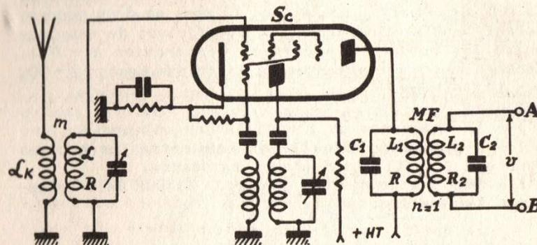
Le circuit d'entrée est un "Bourne à haute inductance". La bobine  $L_k = 4$  millihenrys s'accorde sur 400 kilohertz. Elle est couplée au circuit d'accord; l'induction mutuelle  $m = 300$  microhenrys. La gamme couverte va de 500 à 1500 kilohertz. L'inductance d'accord  $L = 180$  microhenrys a une résistance de 3,2 ohms à 500 kilohertz et 10,8 ohms à 1500 kilohertz.
