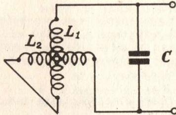
On accorde ce variomètre avec une capacité fixe  $C = 700$  picofarads. On veut couvrir une gamme de fréquences s'étendant de 300 à 500 kilohertz en modifiant simplement le couplage entre les bobines.
