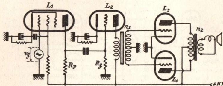
La tension efficace d'attaque  $v_g = 0,05\ \text{volt}$
