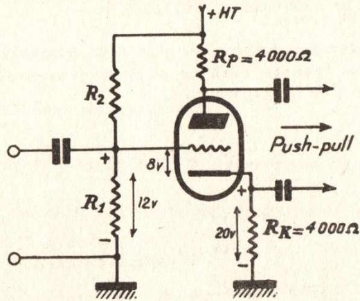
La haute tension étant 250 V (aux bornes de  $R_1 + R_2$ ), si on prend
