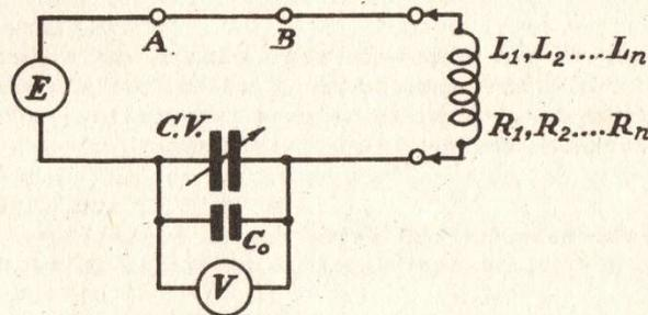
N.B.- Les bornes  $A$  et  $B$  sont normalement en court-circuit.
