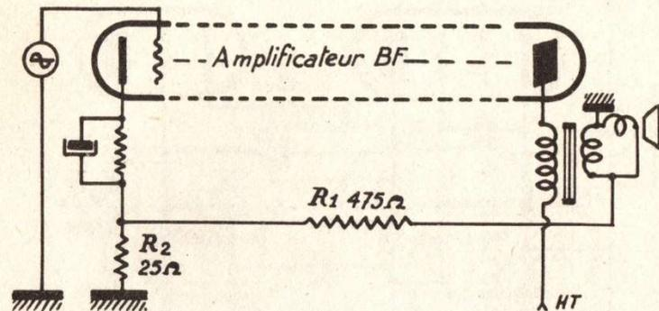
Le gain en tension total de l'amplificateur est 240 sans contre-réaction.
