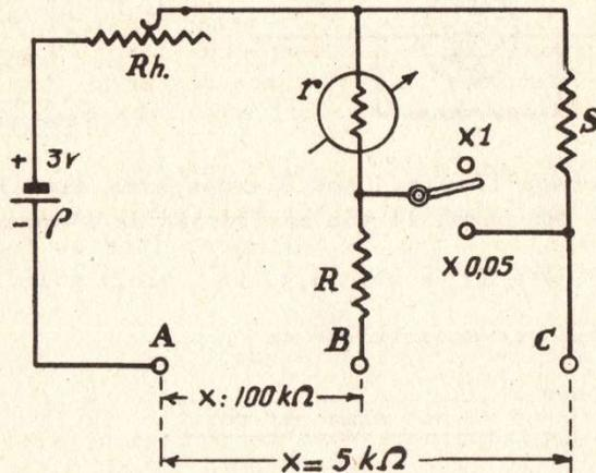
On place en série avec la pile, le rhéostat de tarage ( $R_h$ ), le microampèremètre de résistance  $r$  et une résistance série ( $R$ ).
