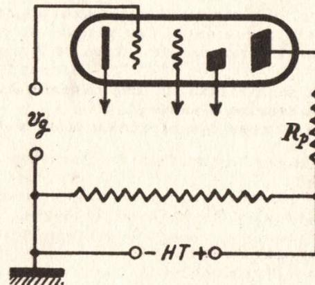
Le circuit anodique est chargé par  $R_p = 10\ 000$  ohms. Les différentes électrodes seront alimentées à partir d'un pont consommant 10 milliampères.
