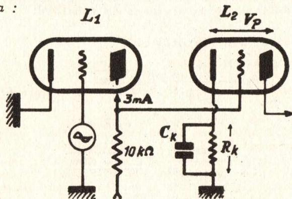
1°) - La tension anodique du tube  $L_1$  est égale à la tension grille de  $L_2$  puisqu'il y a liaison directe.
