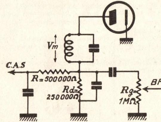
Calculer graphiquement la tension continue et la tension basse fréquence recueillies aux bornes de  $R_d$  si la tension  $V_m = 3$  volts efficaces, modulés à 33 %.
