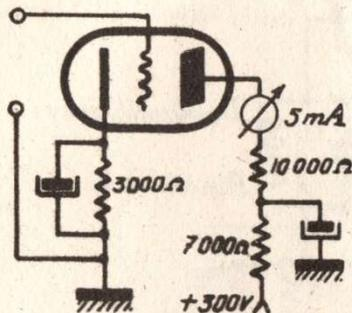
1°) - Sachant que la caractéristique statique  $I_p = f(V_p)$  correspondant à  $V_g = -10$  volts passe par les points  $V_p = 100$  volts,  $I_p = 5$  mA et  $V_p = 200$  volts,  $I_p = 10$  mA, tracer cette caractéristique supposée rectiligne et en déduire graphiquement la résistance interne du tube.
