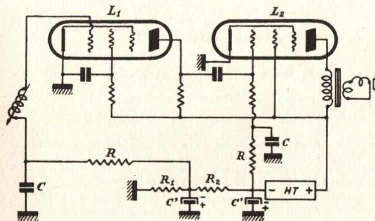
2°) - Les éléments RC constituent un filtre passe-bas, éliminant la tension d'ondulation qui se développe aux bornes des résistances  $R_1$  et  $R_2$ . On prendra les valeurs classiques :
