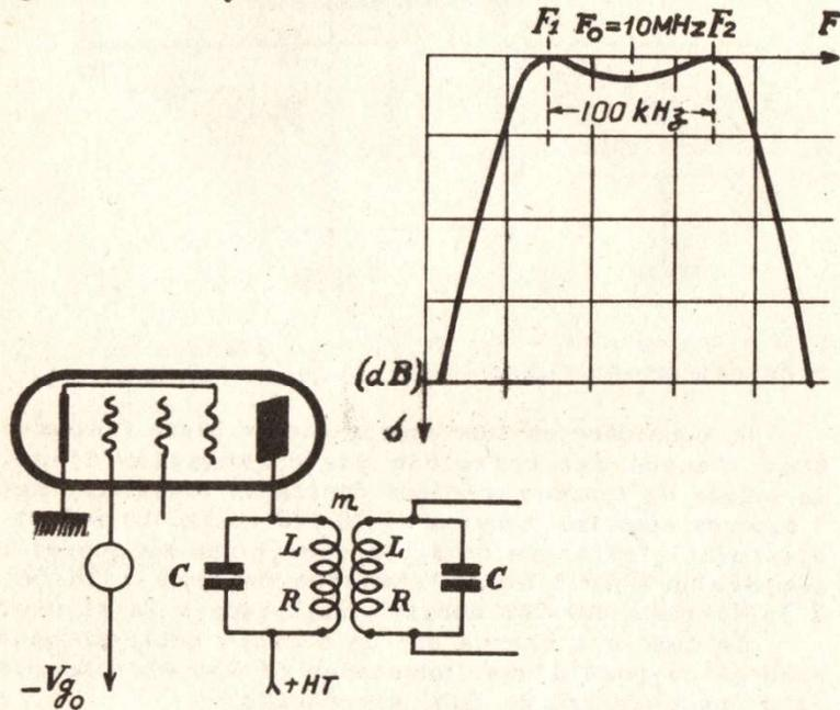
On veut obtenir une courbe de réponse donnant un écart de 100 kilohertz entre deux maxima correspondant aux fréquences  $F_1$  et  $F_2$ .
