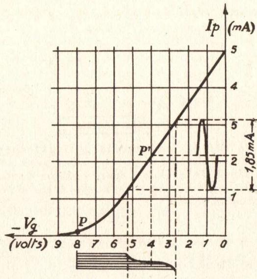
Remarque - On voit sur le graphique, que la valeur de la tension HF et du taux de modulation nous permettent d'obtenir un signal LF exempt de distorsions.
