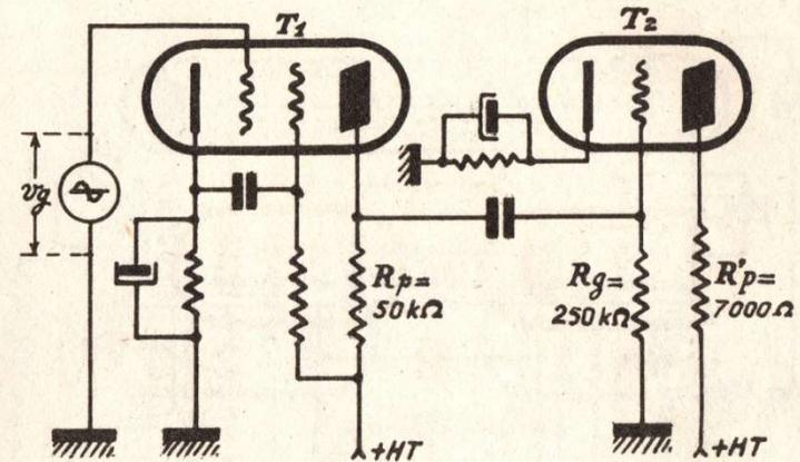
Un amplificateur BF est constitué selon ce schéma. Les constantes des tubes sont :
