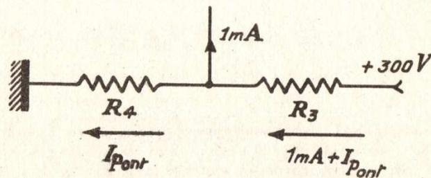
Il reste à déterminer la consommation propre du pont. On a
