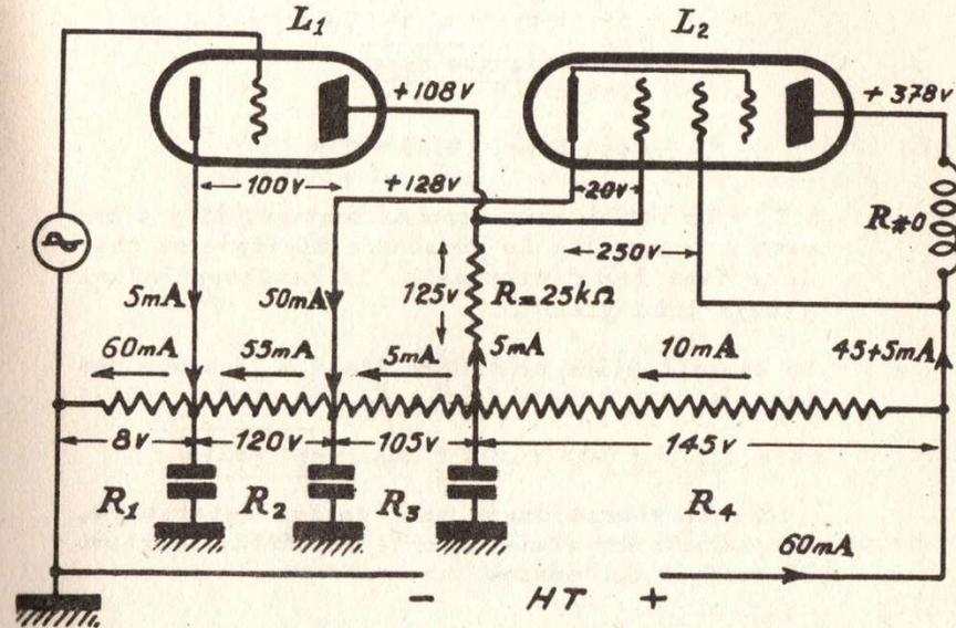
Le schéma est établi en fonction des données. Sur ce schéma on porte les différentes tensions et intensités qui permettront de calculer les résistances du diviseur de tensions.
