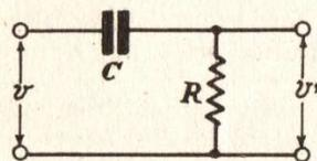
Si  $R = 10\ 000$  ohms, calculer la valeur de  $C$  pour que la tension  $v'$  soit affaiblie de 6 décibels par rapport à la tension  $v$ .
