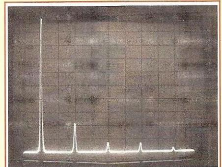
**Figure 3 : Spectre harmonique en échelle linéaire d'une tension redressée à 100 Hz (double alternances). Echelle 50 Hz par carreau. Dès l'harmonique 4 (200 Hz, 2<sup>e</sup> pic), la valeur de crête de la tension n'est plus que de 0,085 fois la tension de crête de la tension alternative à 50 Hz, alors que l'harmonique 2 (100 Hz, 1<sup>er</sup> pic) est de 0,425 fois la tension de crête, ce qui est très important; C'est contre cet harmonique de 100 Hz que l'on va lutter avec le filtrage.**
