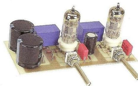
Pour compléter les propos de Monsieur Gest sur les condensateurs en audio, nous vous proposons la réalisation d'un préamplificateur se calquant sur la figure 9 de son article. La triode supérieure est remplacée par une pentode utilisée en pseudo triode du fait que nous avons relié la grille « écran » à l'anode. Nous sommes donc bien dans la même configuration de schéma.
