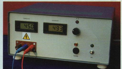
L'alimentation que nous vous proposons délivre une tension réglable de 50 à 450 volts sous un courant de 500 mA. Sa stabilité est de 0,1 %. La résistance interne est inférieure à 0,5  $\Omega$  en statique et 1  $\Omega$  en dynamique de 10 Hz à 100 kHz.
