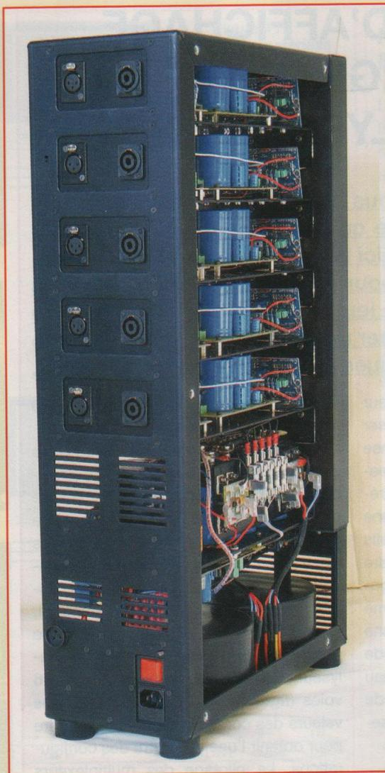
enrober ces colonnettes avec de la gaine thermo pour assurer un isolement supplémentaire entre les condensateurs de l'alimentation générale et le châssis.
