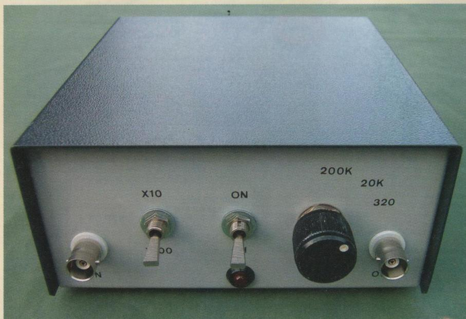
L'appareil étudié ici est un amplificateur auxiliaire de mesure pour oscilloscope ou millivoltmètre AC. Il est principalement destiné aux mesures du bruit et des ronflements qui parasitent nos chères réalisations. Il amplifie les signaux d'un facteur exact de 10 ou 100 avec une bande passante au choix de 200 kHz, 20 kHz ou 320 Hz à -1dB. Il permet à votre oscilloscope de visualiser des signaux de 100 µV sur la gamme 10 mV et même 50 voire 20 µV si votre oscilloscope descend à 5 ou 2 mV.
