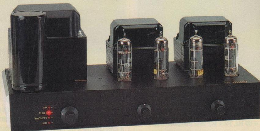
**L'**ECL86 est le tube NOVAL qui permet de réaliser de par son contenu un push-pull dans un minimum d'encombrement, puisque uniquement 2 tubes sont nécessaires pour cette étude.
