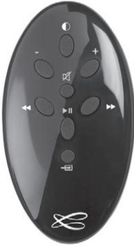
Une fois les connexions Bluetooth et Wi-Fi/Ethernet activées (voir chapitres suivants), sélectionner la source avec des appuis successifs sur la touche **(B)** de la télécommande Stream ou de la face-avant du Stream Amp. Le Stream Amp affiche l'entrée sélectionnée. La LED Wi-fi représente la connexion Wi-Fi, la LED ETH représente la connexion réseau. La solution Ethernet est prioritaire.
