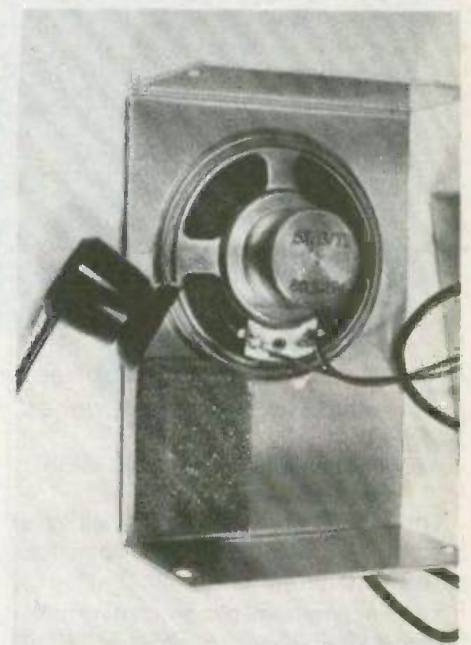
Photo 3. – A l'intérieur du couvercle sont collés le H.P. et le tampon de mousse qui immobilisera la pile.
