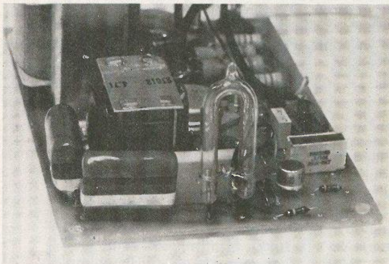
Photo B. – Au premier plan, le tube à éclats 40 joules, les condensateurs de 1 \mu F plaquette et derrière le transformateur d'impulsions.
