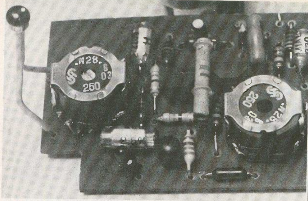
Photo 2. – Gros plan sur les deux bobines faciles à réaliser à l'aide des pots ferrites disponibles chez les spécialistes « télécommande ».
