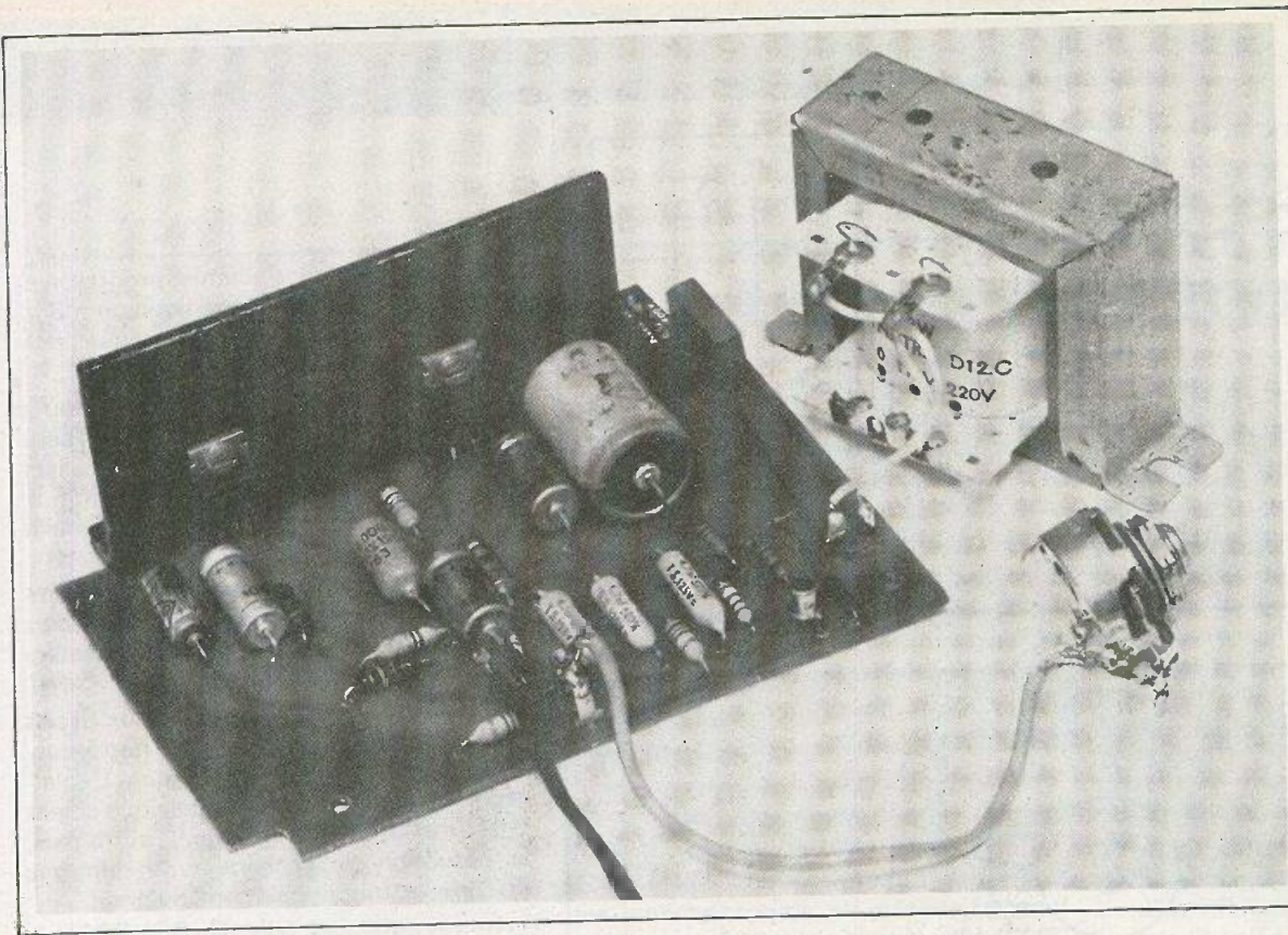
Photo 1. Les composants prendront facilement place sur le circuit imprimé largement dimensionné. On utilisera de préférence un fil blindé pour le potentiomètre P1.
