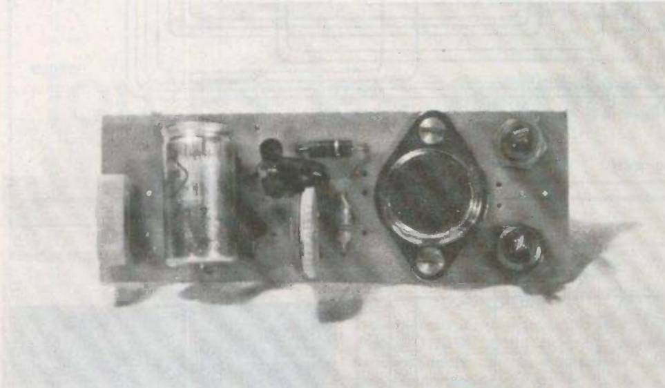
Photo 3. – Les quelques éléments apparaissent en situation. On remarquera, à droite, les deux diodes de puissance.
