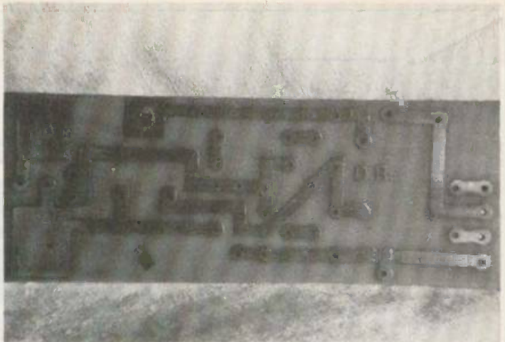
Photo 2. – Le résultat après attaque au perchlorure et nettoyage puis perçage.
