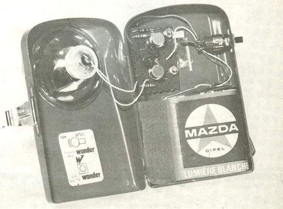
Photo A. - Pour l'émetteur on s'est servi d'un boîtier standard. On a remplacé la pile par une 4,5 V plus petite.
