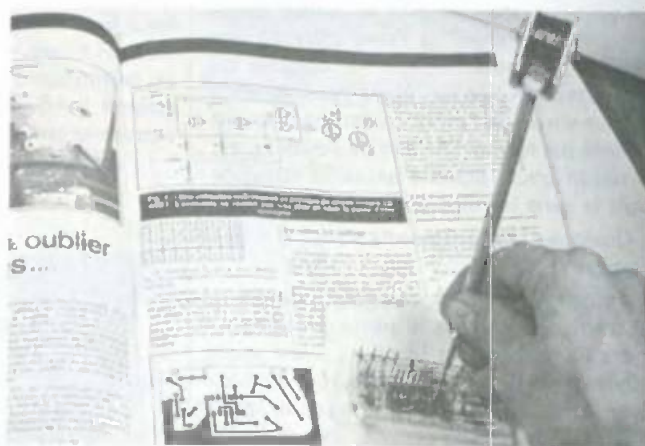
Photo 7. – Après mise en place des composants on procède à une « coupe en brosse » à 1 cm environ du support.
